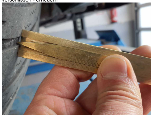
Beschädigung #10: Rad/Reifen: Reifensatz komplett - verschlissen - erneuern
