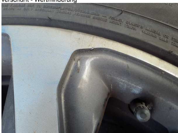
Beschädigung #3: 2.Radsatz: 1 Leichtmetallfelge - verkratzt / verschürft - Wertminderung
