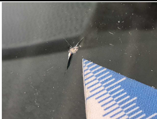
Beschädigung #19: Verglasung: Frontscheibe - Steinschlag - erneuern
