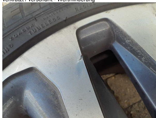
Beschädigung #3: 2.Radsatz: 1 Leichtmetallfelge - verkratzt / verschürft - Wertminderung
