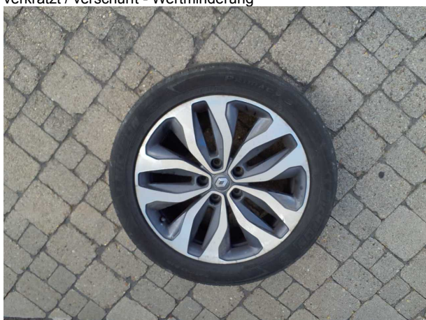
Beschädigung #3: 2.Radsatz: 1 Leichtmetallfelge - verkratzt / verschürft - Wertminderung
