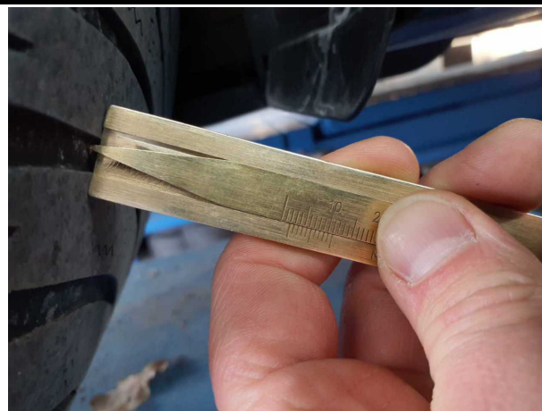
Beschädigung #10: Rad/Reifen: Reifensatz komplett - verschlissen - erneuern
