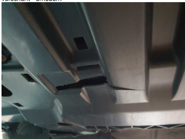
Beschädigung #9: Karosserie: Unterbodenverkleidung - gebrochen / gerissen - erneuern
