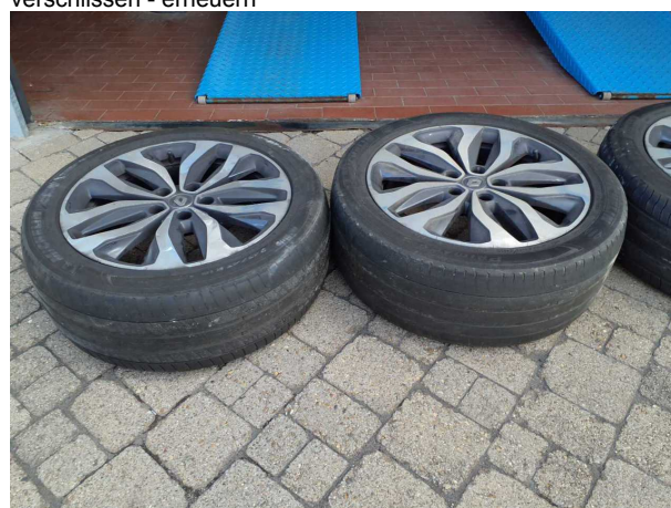
Beschädigung #11: 2.Radsatz: Reifensatz komplett - verschlissen - erneuern
