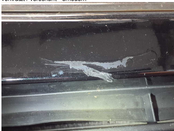
Beschädigung #17: Stossfänger vorn: Stossfänger vorn - verkratzt / verschürft - erneuern
