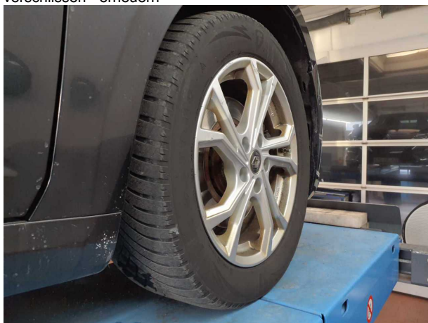
Beschädigung #10: Rad/Reifen: Reifensatz komplett - verschlissen - erneuern
