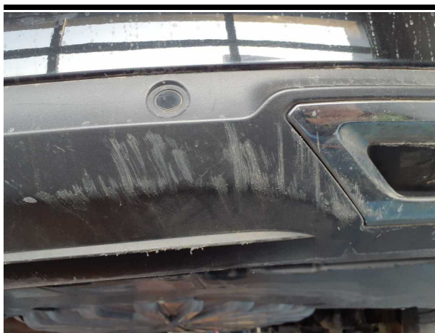
Beschädigung #8: Stossfänger hinten: Spoiler - verkratzt / verschürft - erneuern
