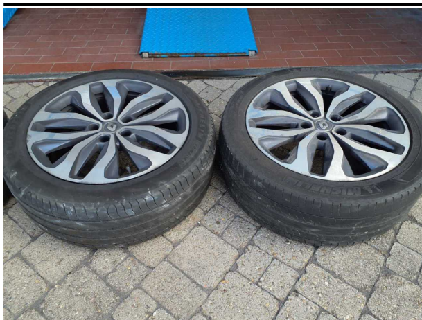
Beschädigung #11: 2.Radsatz: Reifensatz komplett - verschlissen - erneuern
