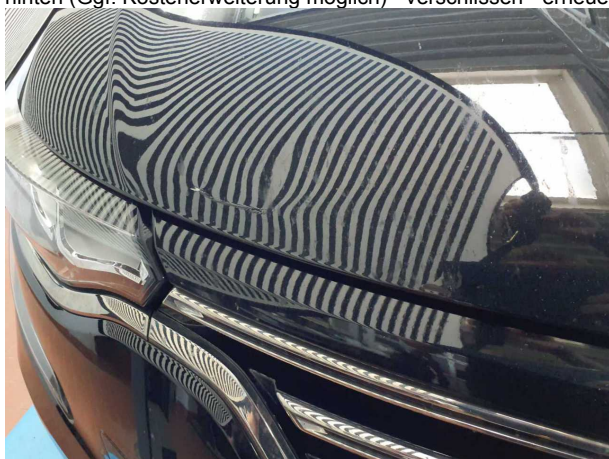
Beschädigung #14: Motorhaube: Motorhaube - Delle / Lackschaden - instandsetzen und lackieren
