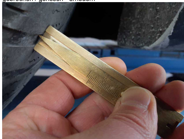
Beschädigung #10: Rad/Reifen: Reifensatz komplett - verschlissen - erneuern
