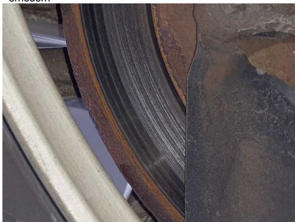
Beschädigung #13: Bremsanlage: Bremsscheiben und Beläge hinten (Ggf. Kostenerweiterung möglich) - verschlissen - erneuern
