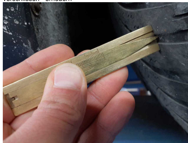
Beschädigung #10: Rad/Reifen: Reifensatz komplett - verschlissen - erneuern
