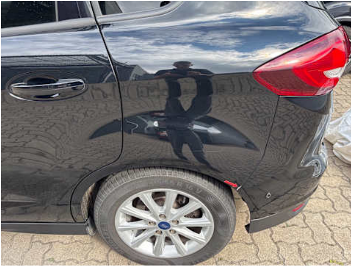
Seitenteil hinten links (Rost, Kratzer)
