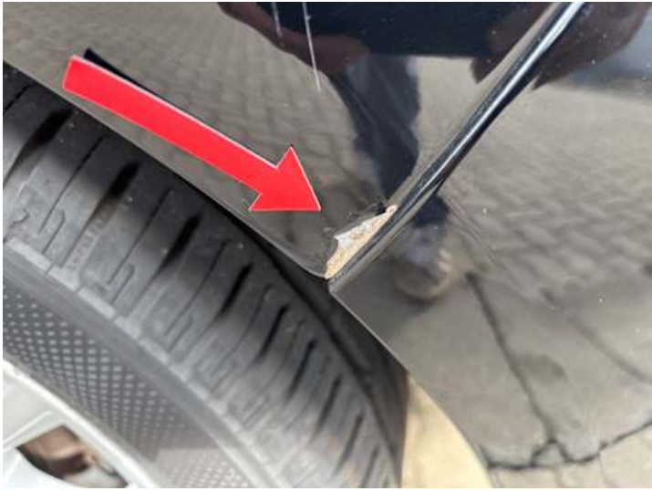
Seitenteil hinten links (Rost, Kratzer)
