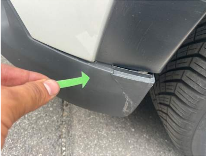
Stoßstange vorne (Spaltmaße ungenau, Riss/Bruch)
