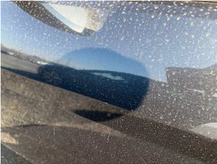
Fahrtür (Lackschaden, Kratzer)
