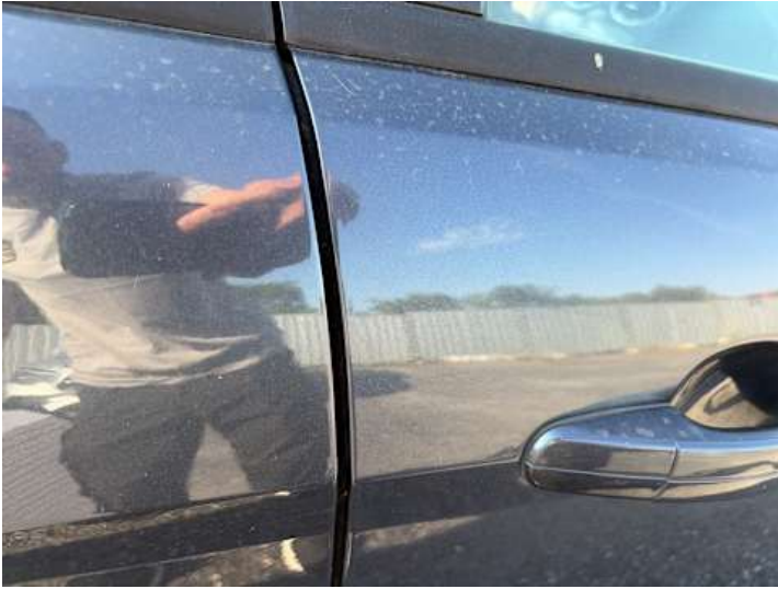
Beifahrertür (Lackschaden, Kratzer)
