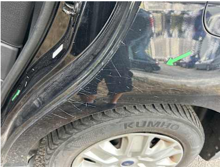
Seitenteil hinten links (Kratzer, Delle)
