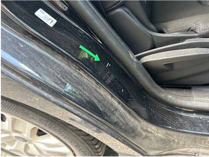
Seitenteil hinten rechts (Kratzer, Delle)
