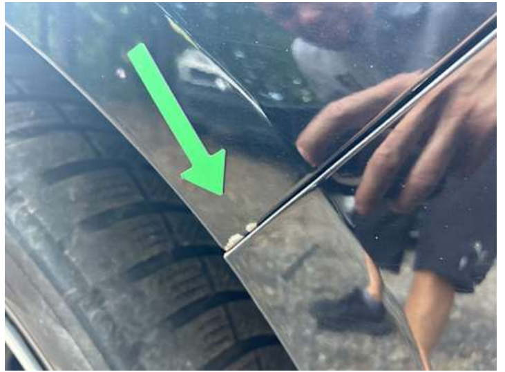
Kotflügel vorne rechts (Kratzer, Rost, Delle)
