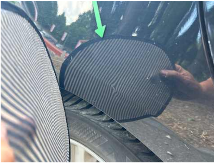
Seitenteil hinten rechts (Delle, Kratzer)
