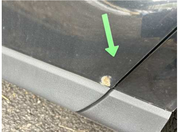
Türe hinten links (Rost, Kratzer)
