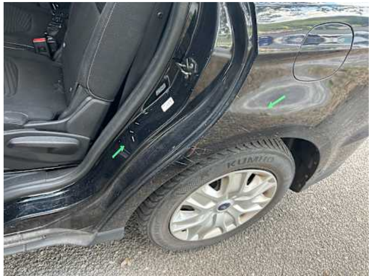
Seitenteil hinten links (Kratzer, Delle)
