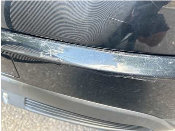
Stoßstange hinten (Kratzer, Verformung)
