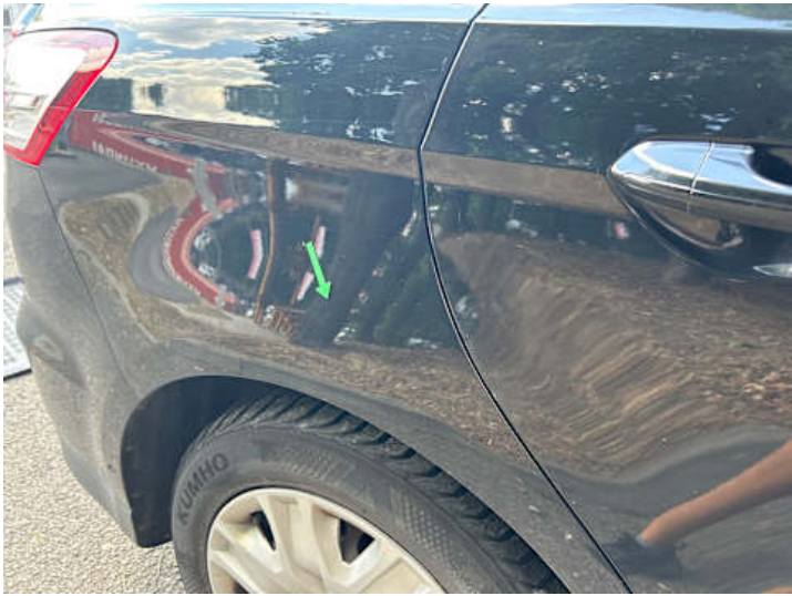
Seitenteil hinten rechts (Delle, Kratzer)
