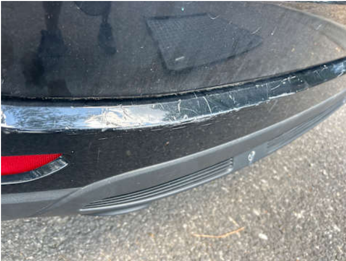
Stoßstange hinten (Kratzer, Verformung)
