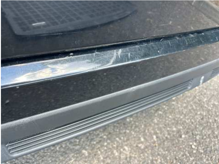
Stoßstange hinten (Kratzer, Verformung)
