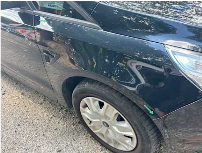
Kotflügel vorne rechts (Kratzer, Rost, Delle)
