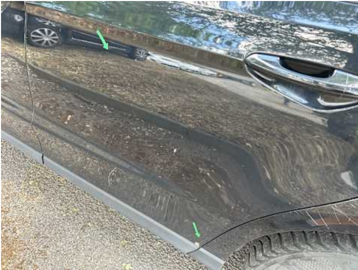
Türe hinten links (Rost, Kratzer)
