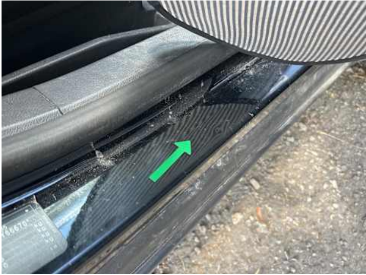
Schweller rechts (Delle, Kratzer)
