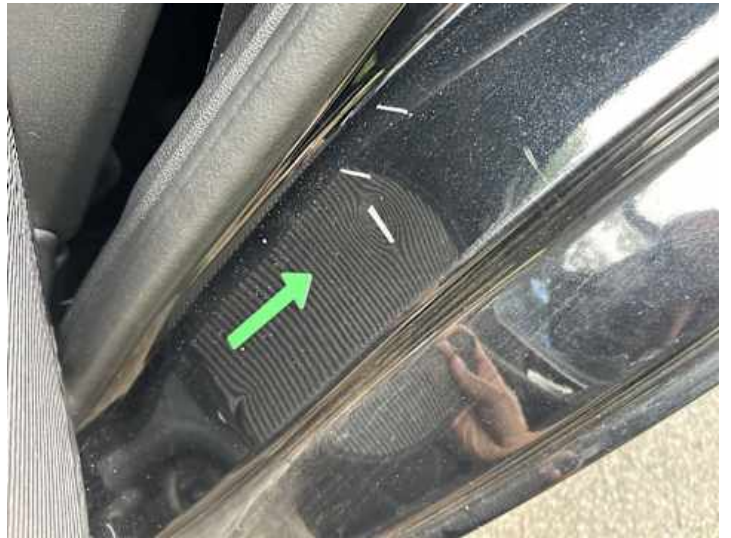
Seitenteil hinten links (Kratzer, Delle)
