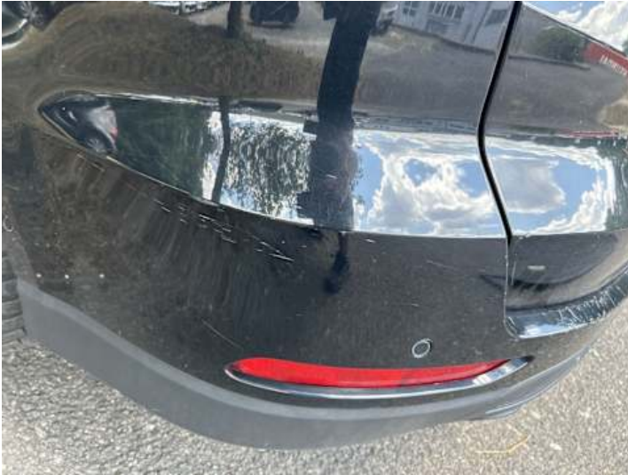
Stoßstange hinten (Kratzer, Verformung)
