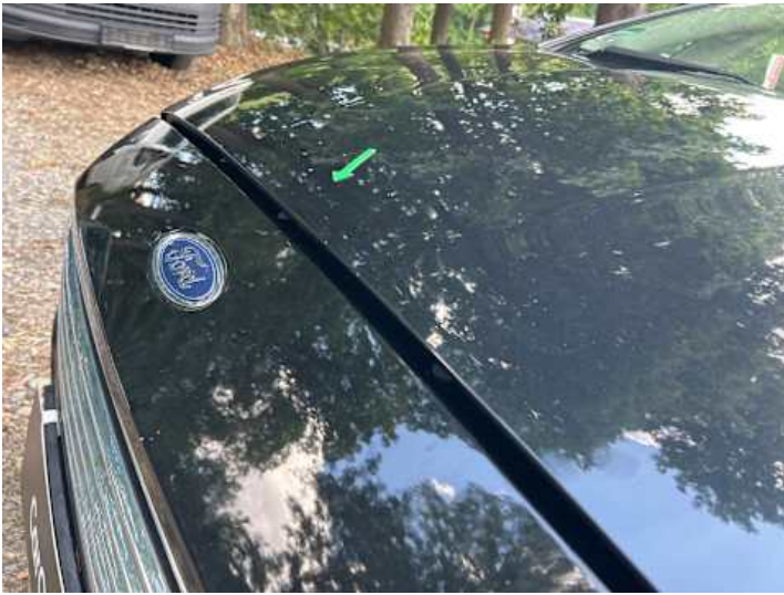
Motorhaube (Spaltmaße ungenau, Anderer Schaden, Steinschlag): Schließt nicht vollständig
