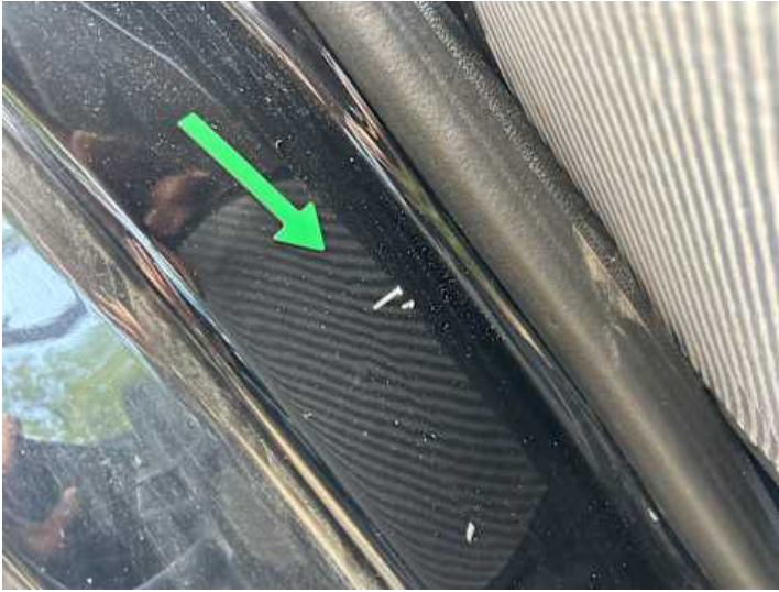
Seitenteil hinten rechts (Kratzer, Delle)
