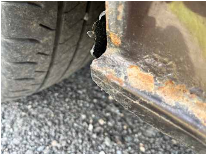
Schweller links (Rost)
