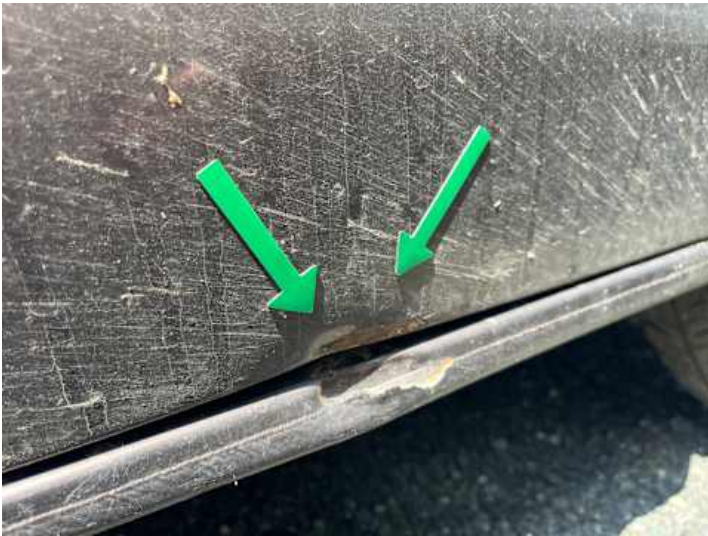
Beifahrertür (Lackschaden, Verformung)
