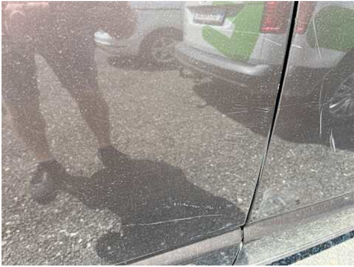
Seitenteil hinten rechts (Lackschaden, Kratzer)
