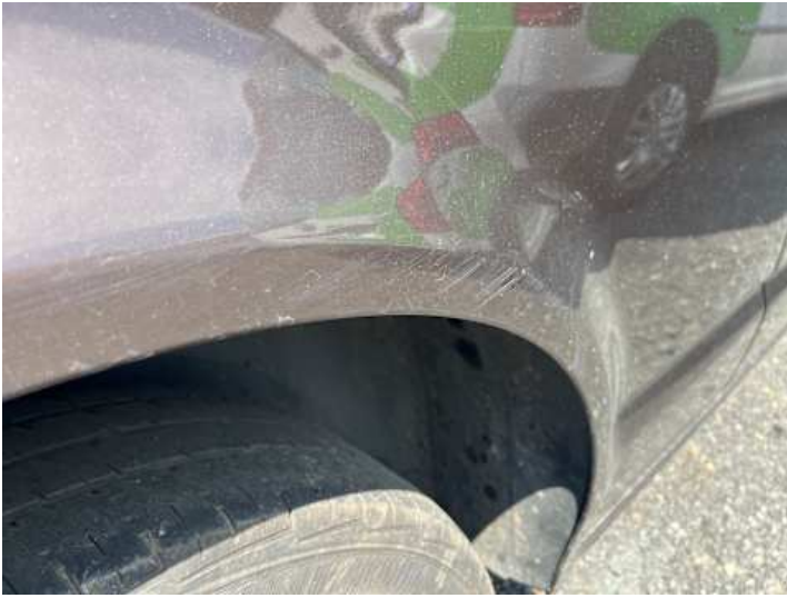
Seitenteil hinten rechts (Lackschaden, Kratzer)
