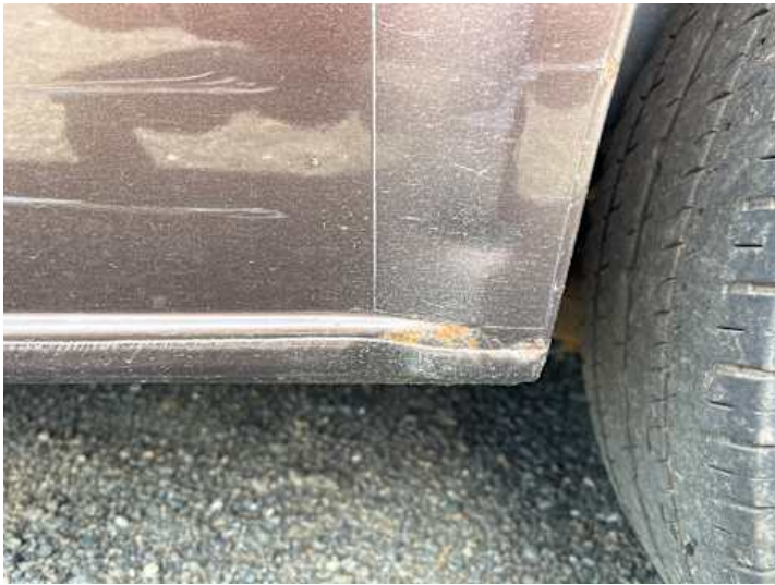
Seitenteil hinten links (Rost)
