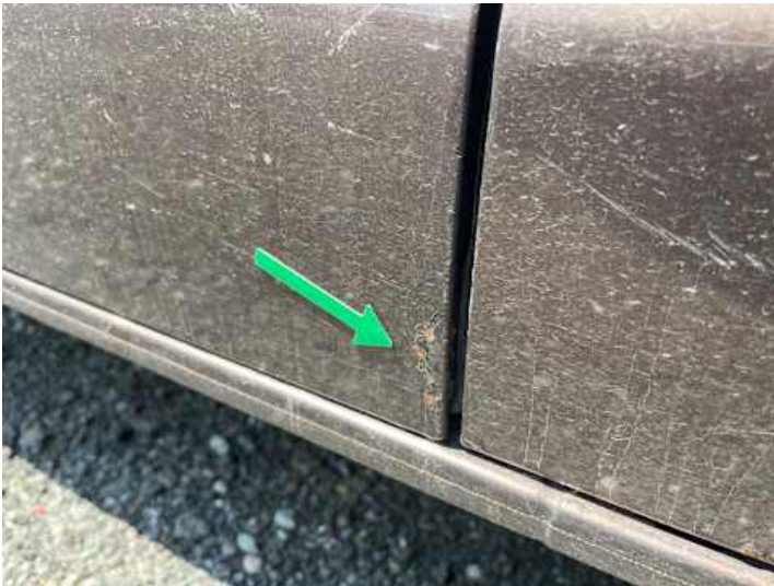
Türe hinten rechts (Rost)
