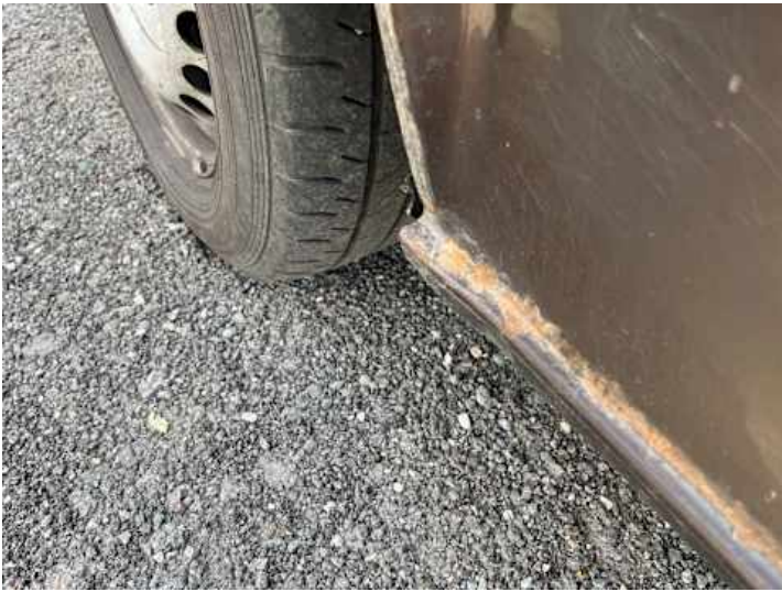
Schweller links (Rost)
