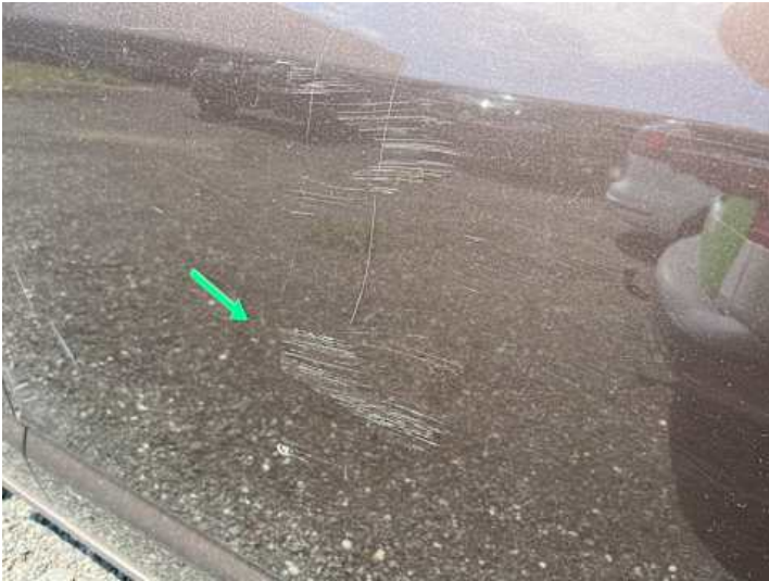
Türe hinten rechts (Kratzer, Lackschaden)
