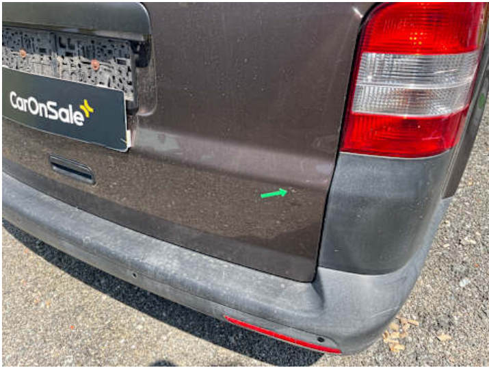
Heckklappe (Delle, Lackschaden, Rost)
