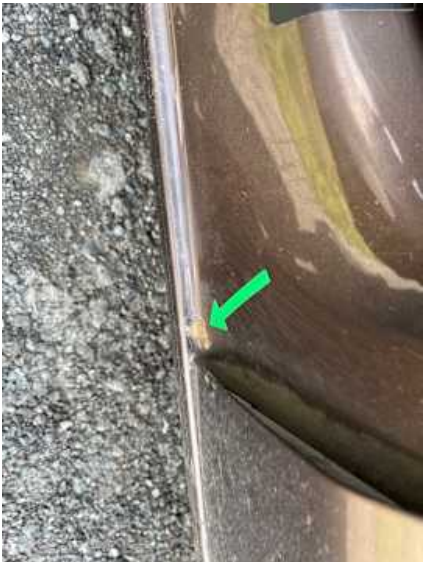
Schweller links (Rost)
