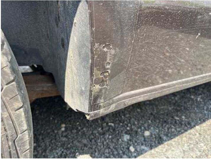
Seitenteil hinten rechts (Rost)
