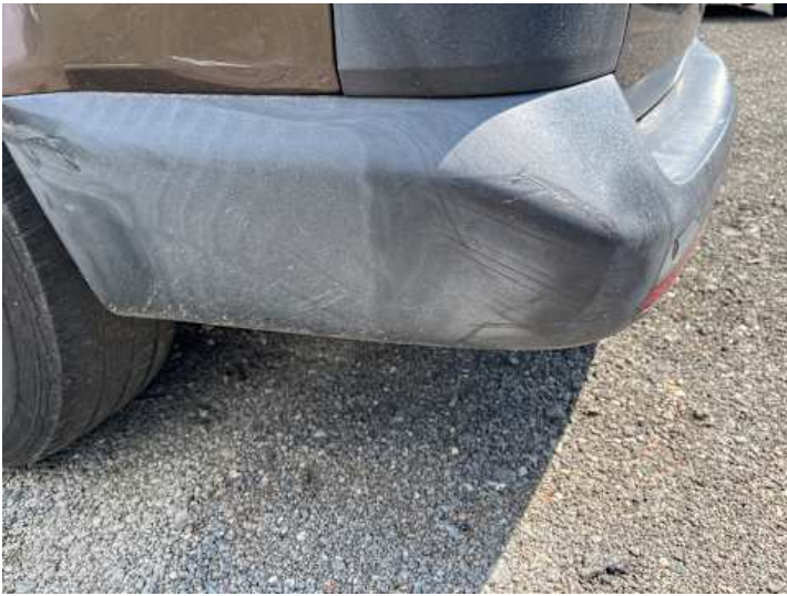
Stoßstange hinten (Kratzer)
