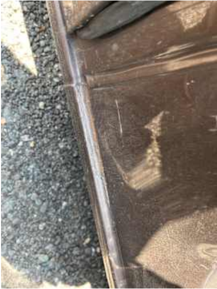
Schweller rechts (Rost)
