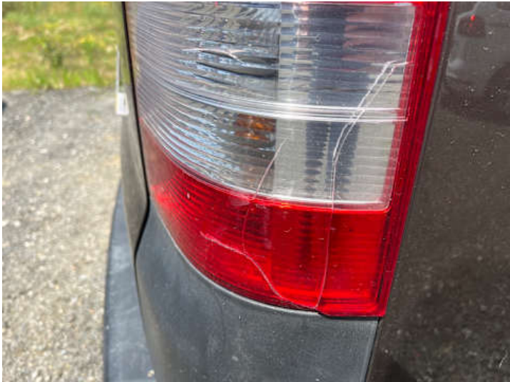
Rücklicht (rechts) (Riss/Bruch)
