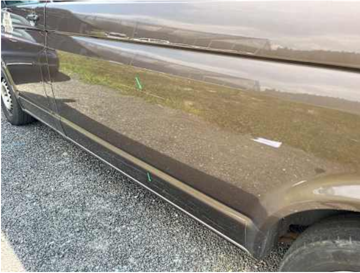
Seitenteil hinten links (Lackschaden, Kratzer)
