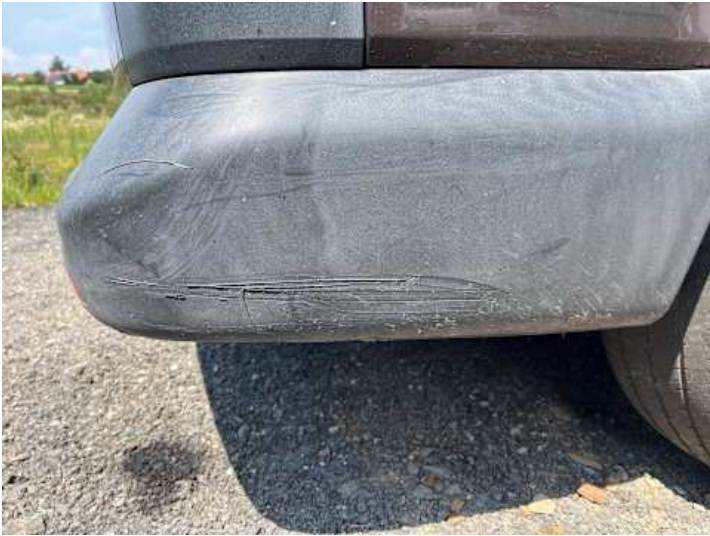
Stoßstange hinten (Kratzer)
