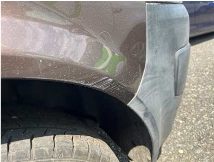
Kotflügel vorne rechts (Lackschaden)
