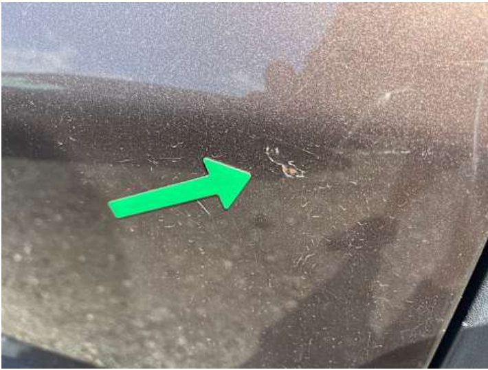
Heckklappe (Delle, Lackschaden, Rost)
