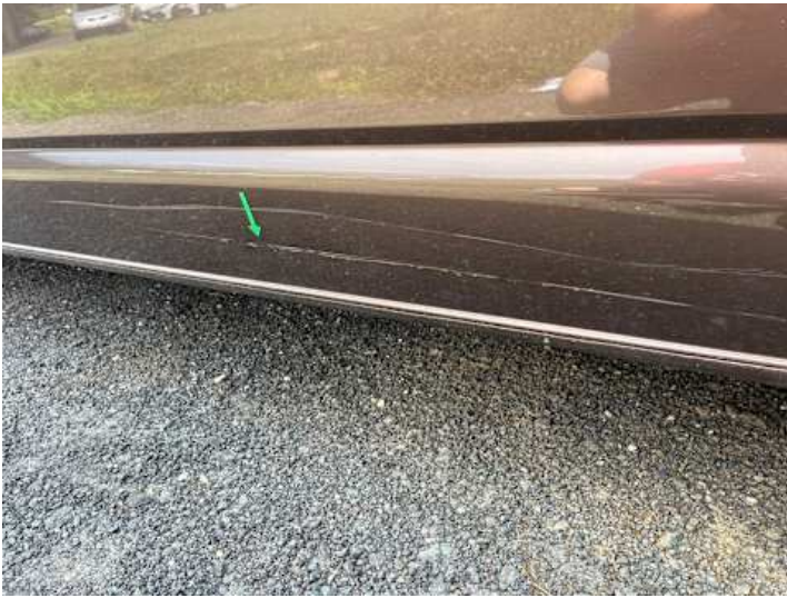
Seitenteil hinten links (Lackschaden, Kratzer)
