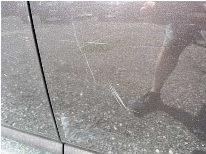
Türe hinten rechts (Kratzer, Lackschaden)
