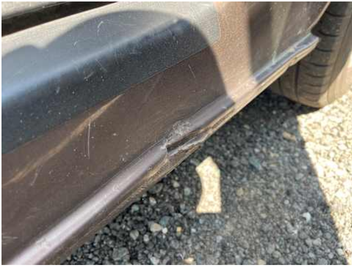
Schweller rechts (Lackschaden, Verformung)
