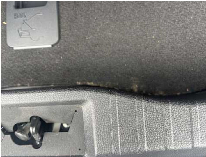
Innenraum (Anderer Schaden): Schimmel
