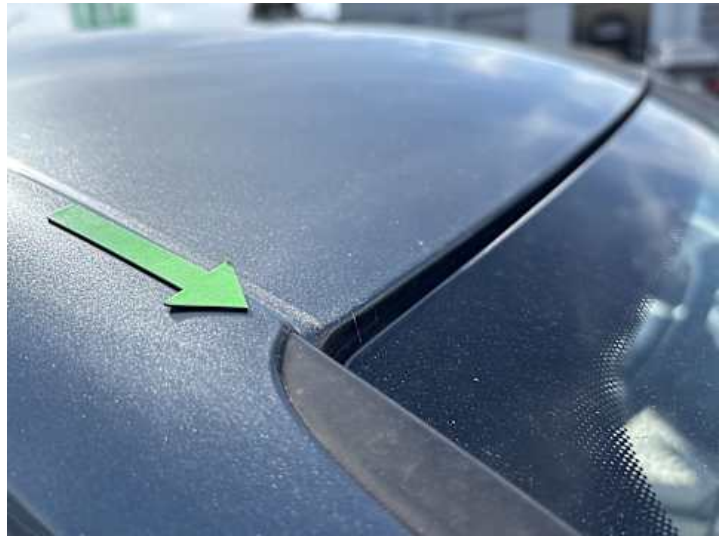
Dach (Delle, Steinschlag)
