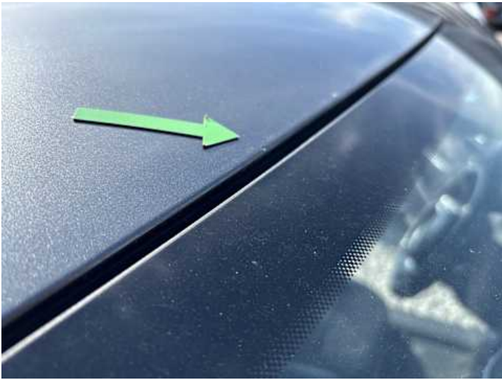
Dach (Delle, Steinschlag)
