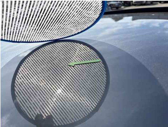
Dach (Delle, Steinschlag)
