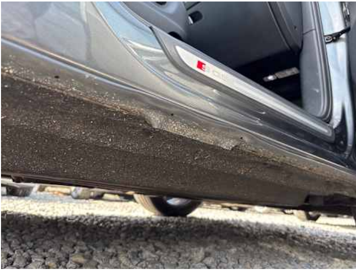
Schweller rechts (Riss/Bruch)
