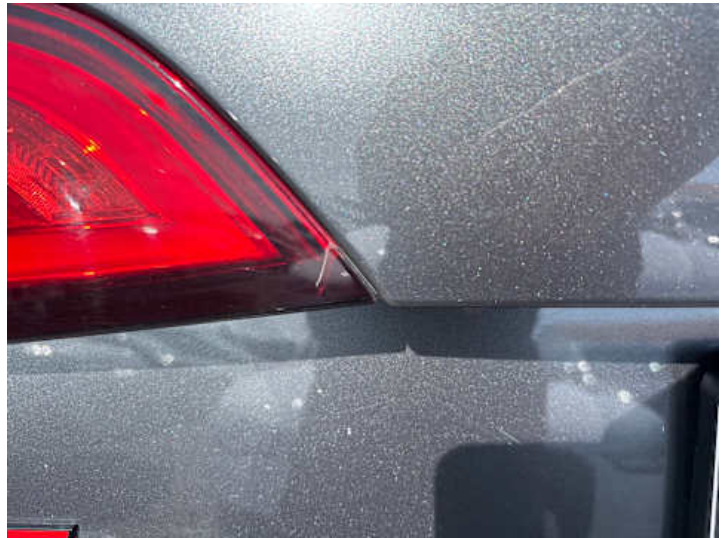
Rücklicht (links) (Riss/Bruch)
