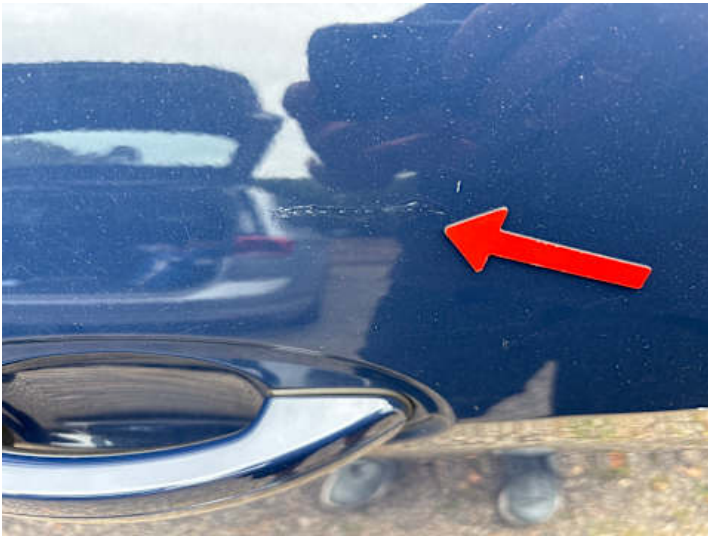
Türe hinten links (Kratzer, Unsachgemäß instand gesetzt)
