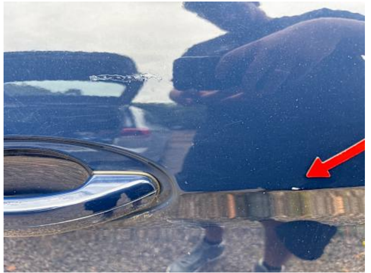
Türe hinten links (Kratzer, Unsachgemäß instand gesetzt)
