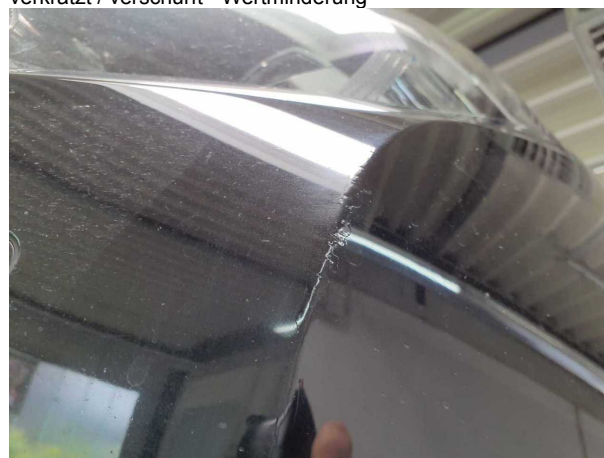
Beschädigung #3: Stossfänger vorn: Stossfänger vorn (Mehrkosten möglich) - verkratzt / verschürft - instandsetzen
