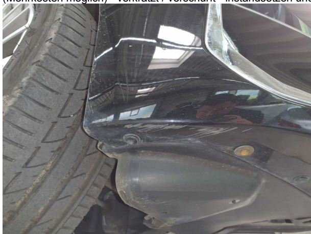
Beschädigung #3: Stossfänger vorn: Stossfänger vorn (Mehrkosten möglich) - verkratzt / verschürft - instandsetzen und
