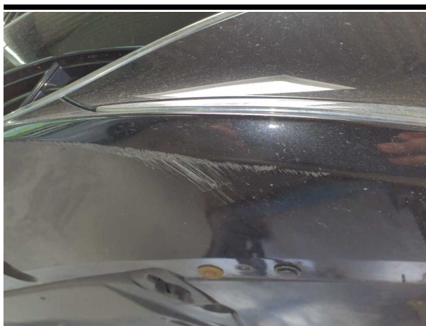
Beschädigung #3: Stossfänger vorn: Stossfänger vorn (Mehrkosten möglich) - verkratzt / verschürft - instandsetzen und
