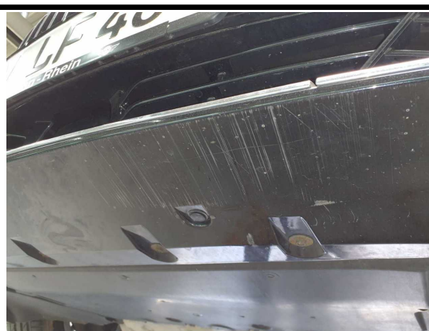
Beschädigung #3: Stossfänger vorn: Stossfänger vorn (Mehrkosten möglich) - verkratzt / verschürft - instandsetzen
