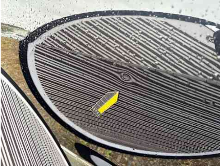
Fahrtür (Delle, Kratzer)
