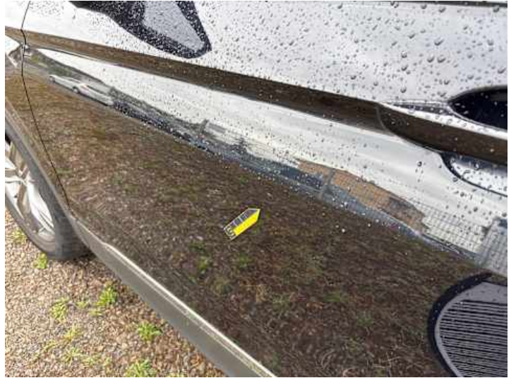
Fahrtür (Delle, Kratzer)
