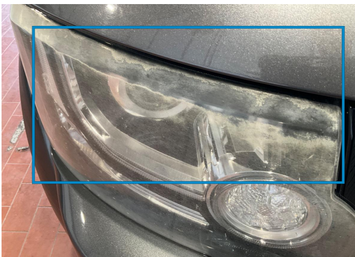
2. Vorderlicht / Vorne Rechts Lack / Chemische Schäden -
