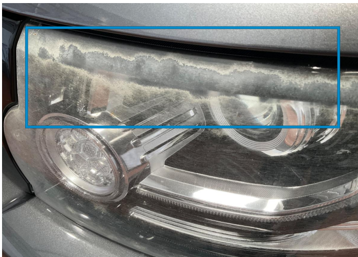
5. Vorderlicht / Vorne Links Glasbruch / Gesprungen -
