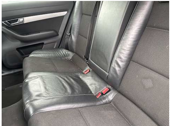
Innenraum (Anderer Schaden): Druckstellen.
