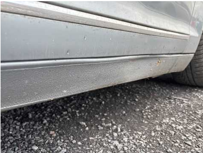
Schweller rechts (Verformung)
