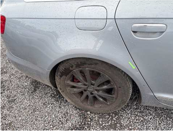
Seitenteil hinten rechts (Rost, Verformung)
