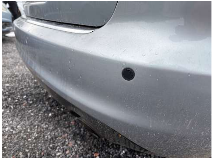
Stoßstange hinten (Anderer Schaden): PDC Sensor nicht Lackiert.
