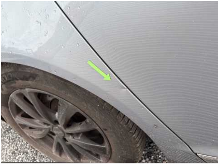
Seitenteil hinten rechts (Rost, Verformung)
