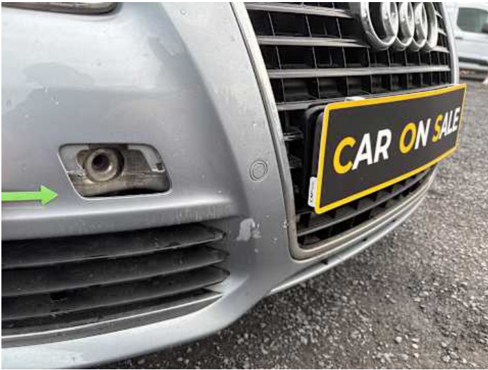
Stoßstange vorne (Lackschaden, Riss/Bruch)
