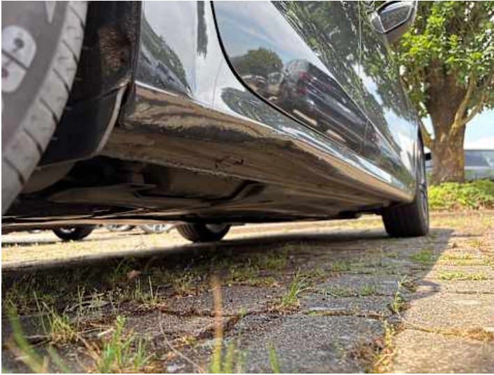
Schweller rechts (Verformung, Kratzer)
