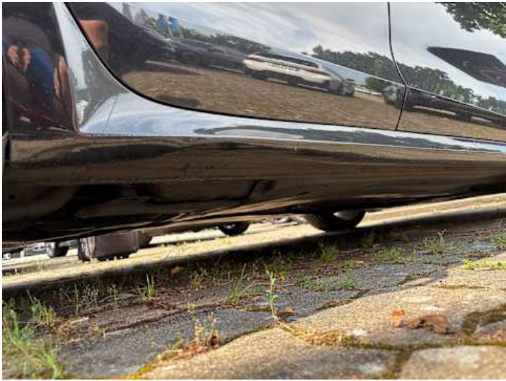
Schweller rechts (Verformung, Kratzer)
