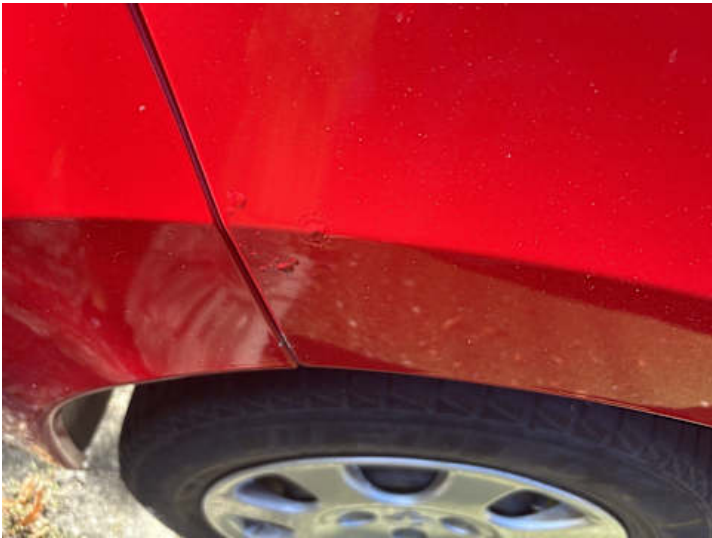
Seitenteil hinten rechts (Rost)
