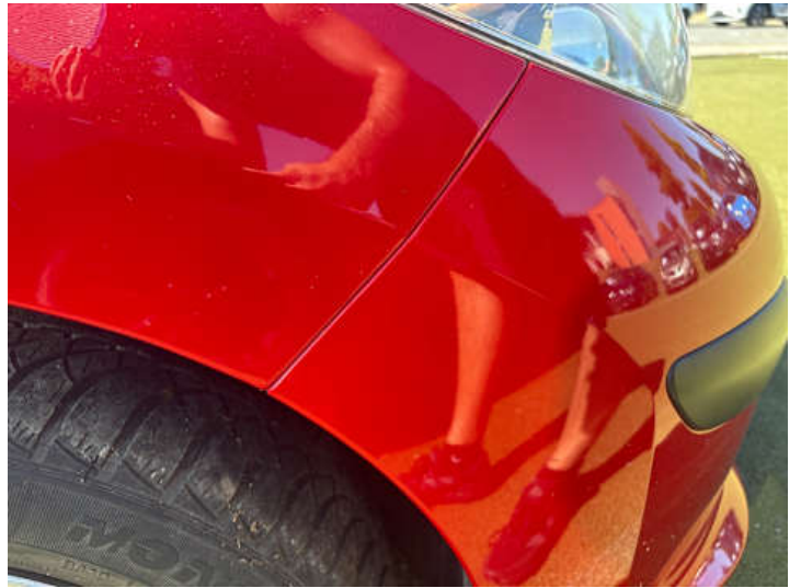
Stoßstange vorne (Spaltmaße ungenau)
