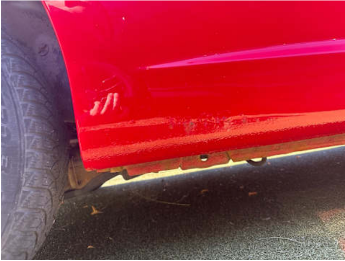
Schweller rechts (Rost)
