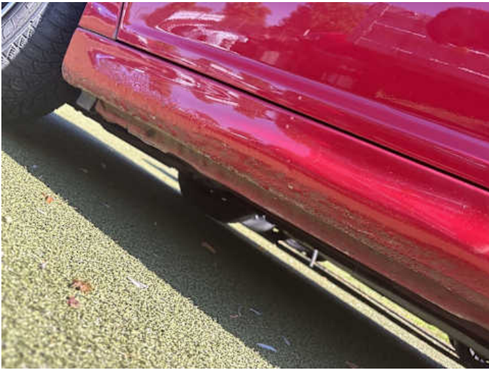
Schweller links (Rost, Verformung)
