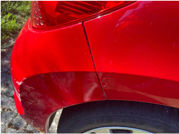
Stoßstange hinten (Spaltmaße ungenau)
