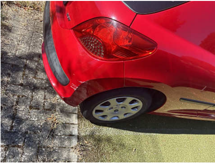
Stoßstange hinten (Spaltmaße ungenau)
