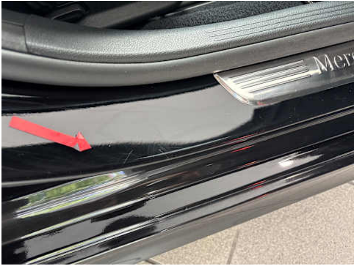
Schweller rechts (Kratzer)
