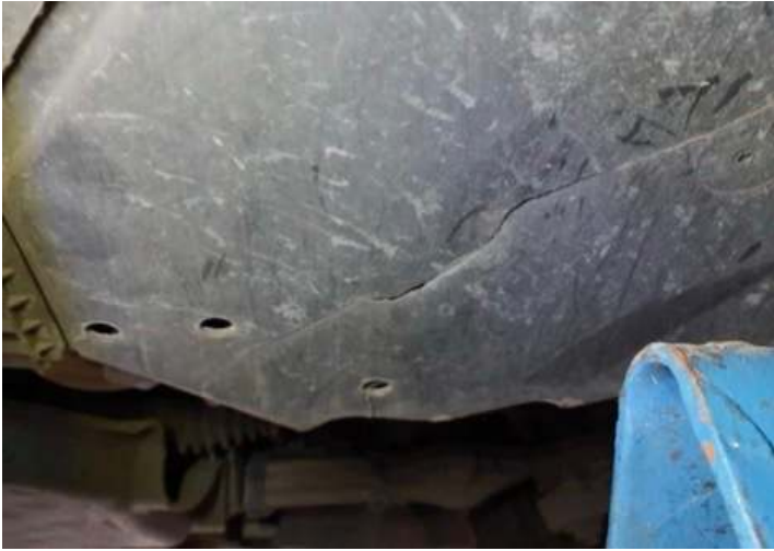
Stoßstange vorne (Anderer Schaden): Unterbodenverkleidung Riss/Bruch
