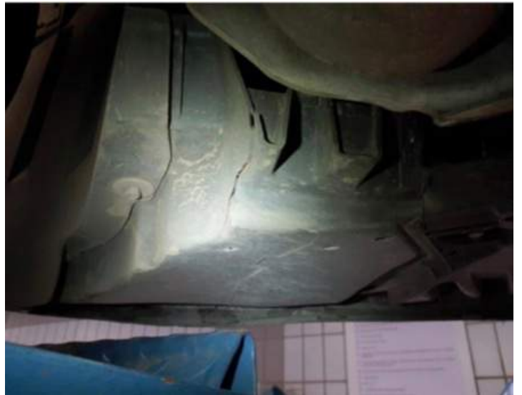
Stoßstange vorne (Anderer Schaden): Unterbodenverkleidung Riss/Bruch
