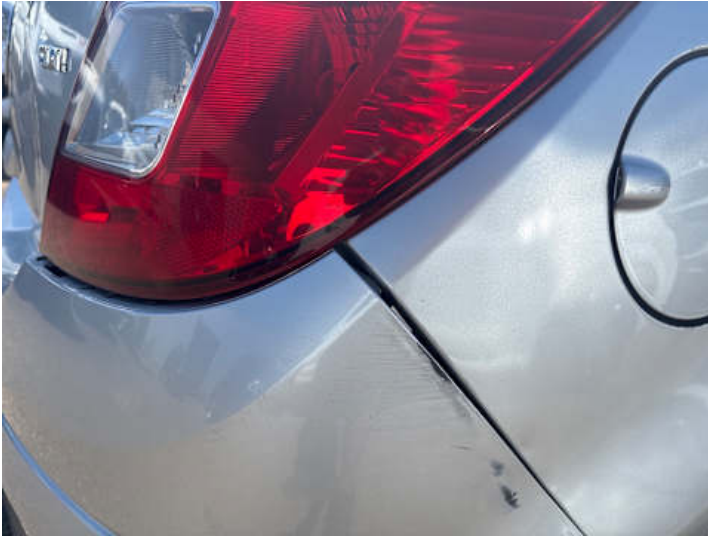
Stoßstange hinten (Lackschaden, Kratzer, Spaltmaße ungenau)
