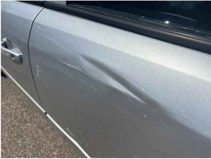
Türe hinten links (Lackschaden, Kratzer, Verformung)
