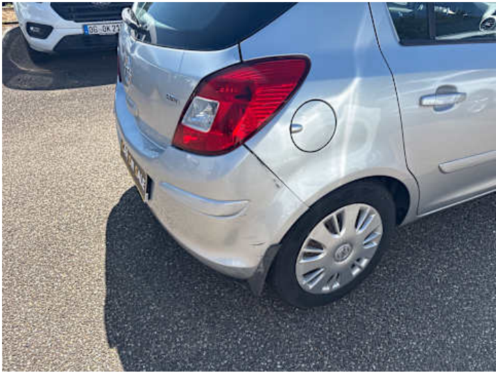
Stoßstange hinten (Lackschaden, Kratzer, Spaltmaße ungenau)
