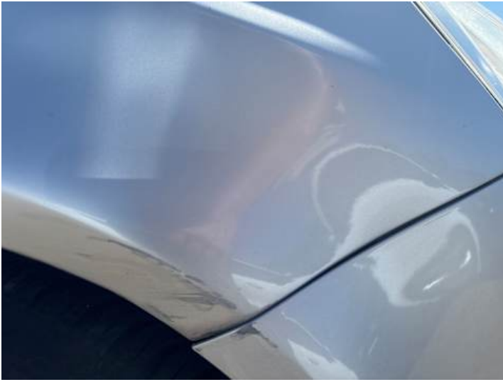
Kotflügel vorne rechts (Lackschaden, Kratzer, Verformung)
