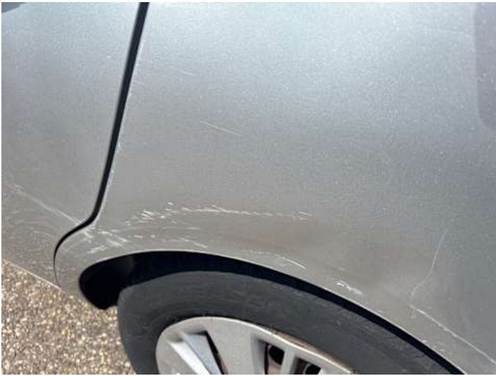
Seitenteil hinten links (Lackschaden, Kratzer, Verformung)
