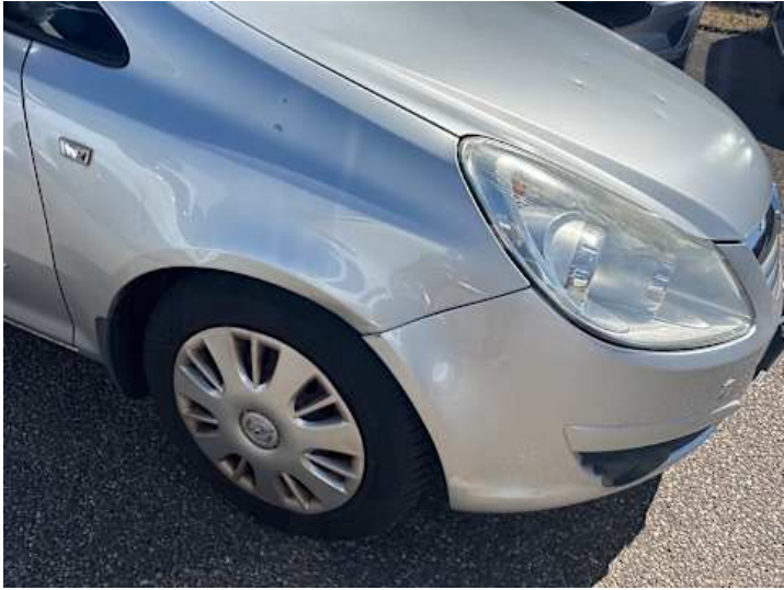
Kotflügel vorne rechts (Lackschaden, Kratzer, Verformung)
