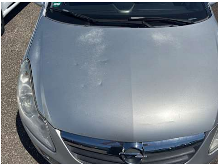
Motorhaube (Lackschaden, Delle)
