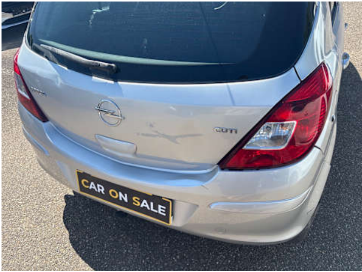
Heckklappe (Lackschaden, Verformung)
