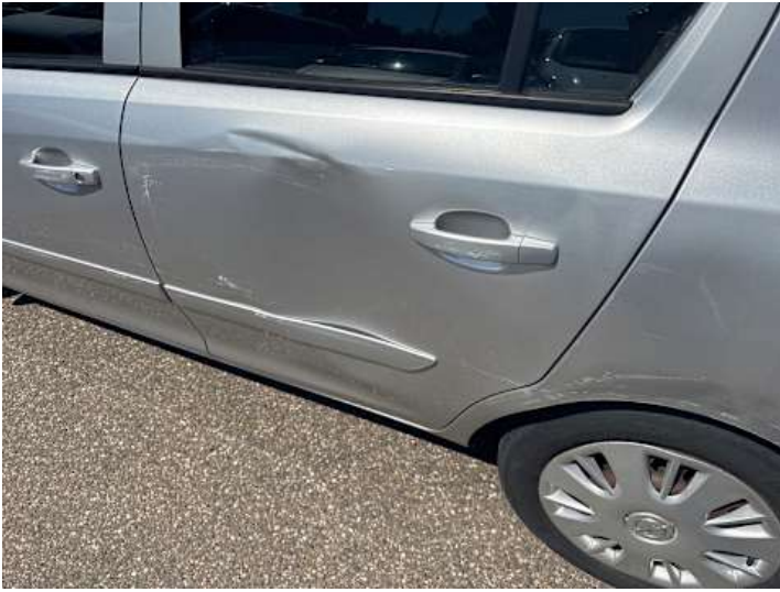
Türe hinten links (Lackschaden, Kratzer, Verformung)
