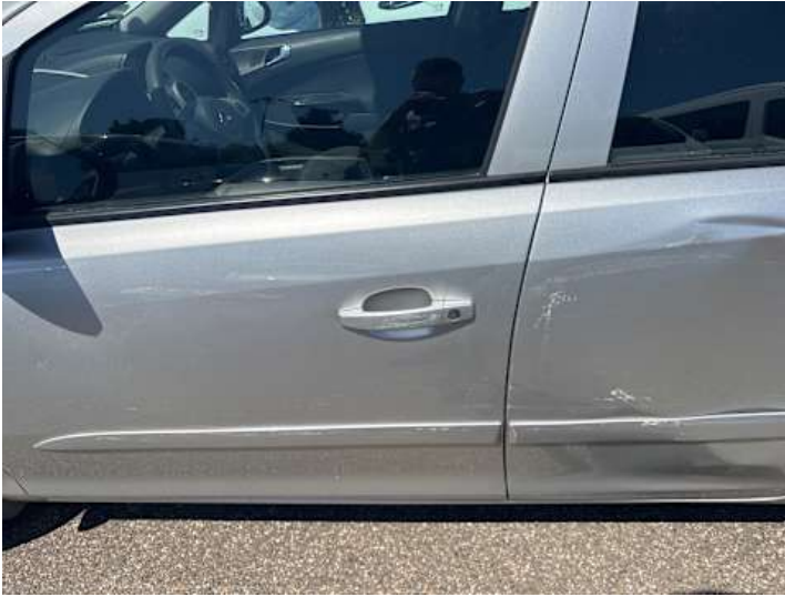
Fahrtür (Lackschaden, Kratzer)
