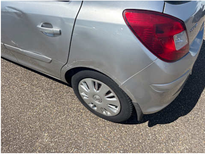
Seitenteil hinten links (Lackschaden, Kratzer, Verformung)
