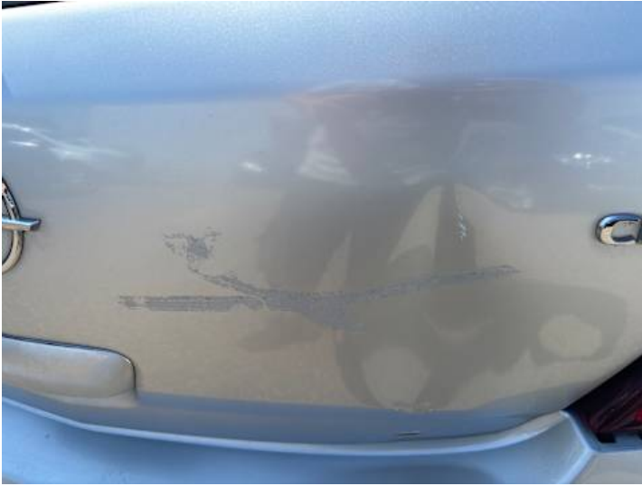
Heckklappe (Lackschaden, Verformung)
