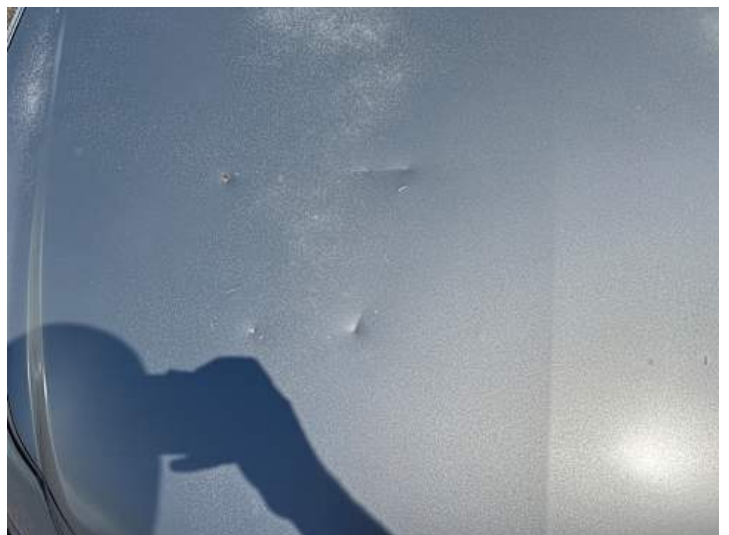
Motorhaube (Lackschaden, Delle)
