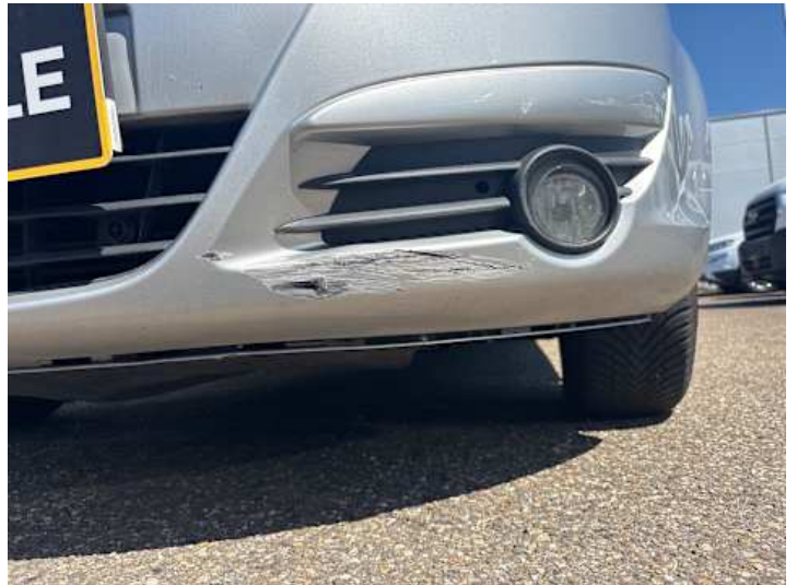
Stoßstange vorne (Lackschaden, Kratzer)
