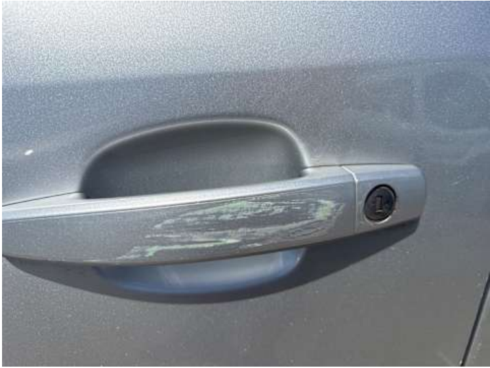
Fahrtür (Lackschaden, Kratzer)
