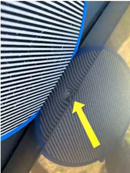
Heckklappe (Delle, Lackschaden)
