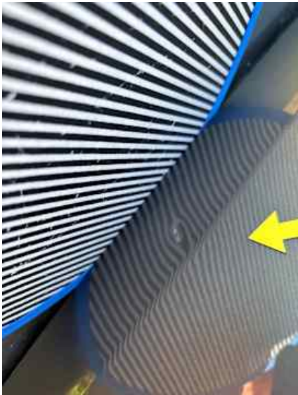
Heckklappe (Delle, Lackschaden)
