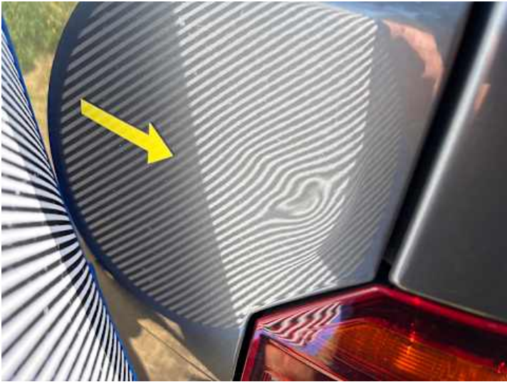
Heckklappe (Delle, Lackschaden)
