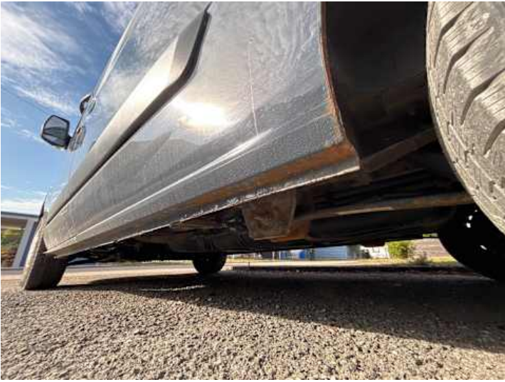
Schweller links (Rost)
