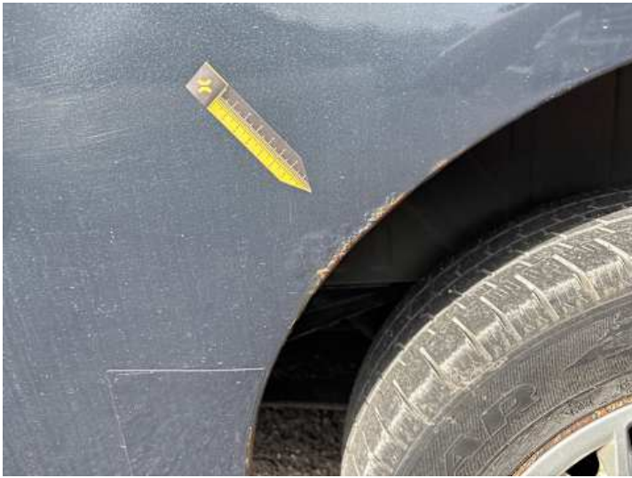
Seitenteil hinten links (Rost)
