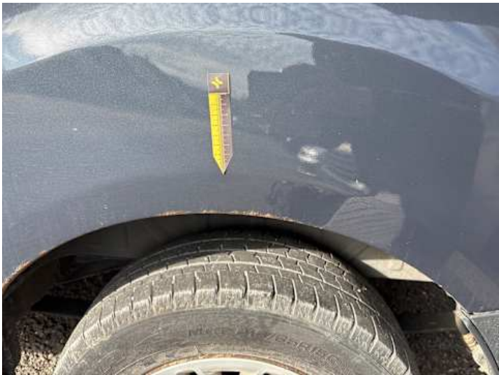
Seitenteil hinten links (Rost)
