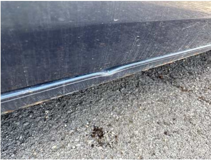
Schweller rechts (Rost, Verformung)
