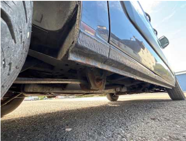
Schweller rechts (Rost, Verformung)
