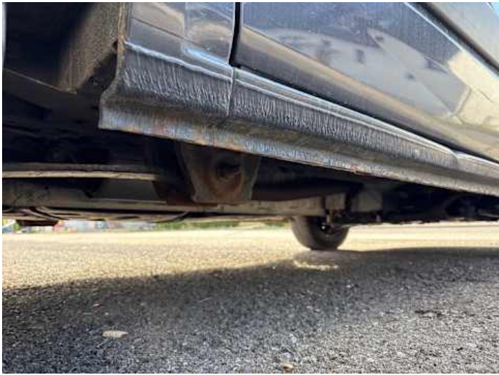
Schweller rechts (Rost, Verformung)
