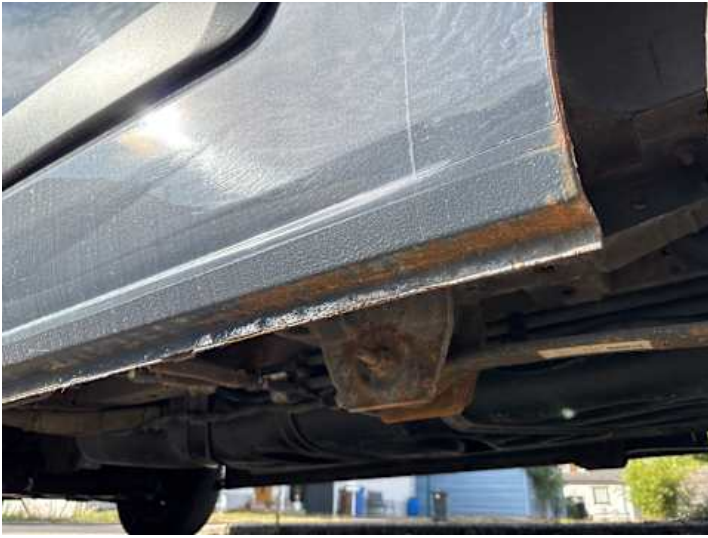
Schweller links (Rost)
