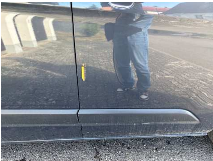
Beifahrtür (Delle, Lackschaden)
