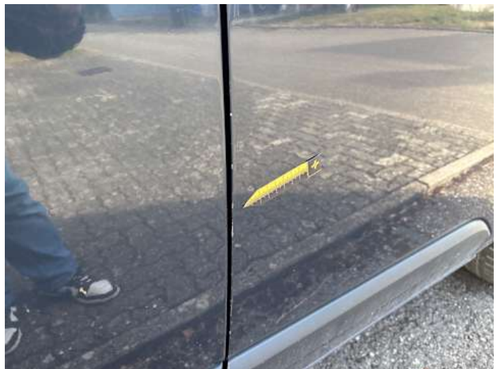
Beifahrtür (Delle, Lackschaden)
