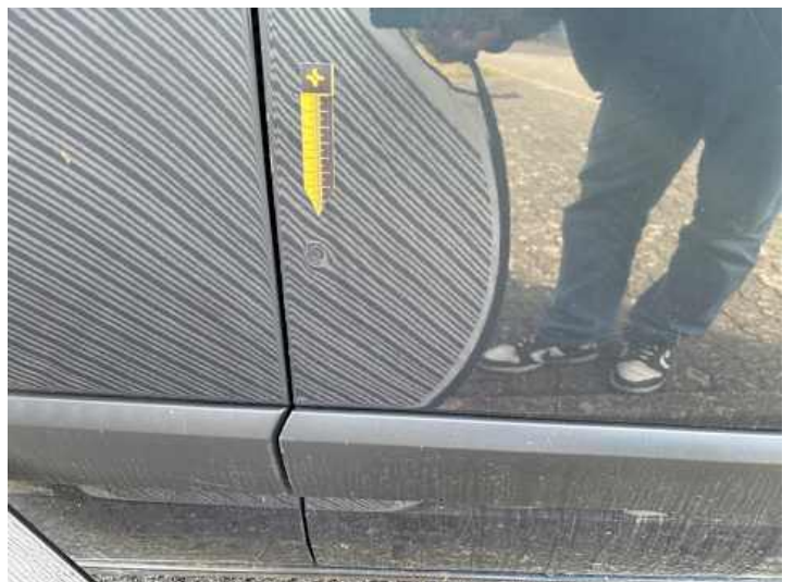
Beifahrtür (Delle, Lackschaden)
