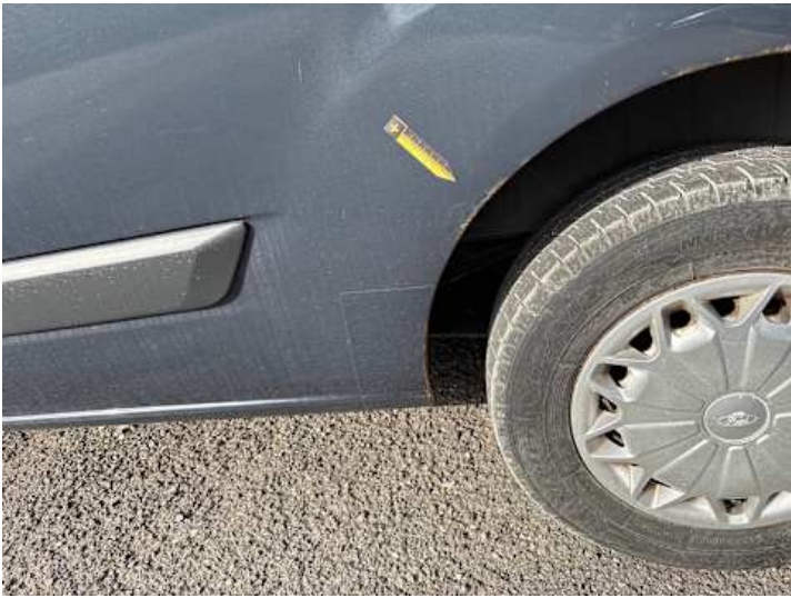
Seitenteil hinten links (Rost)
