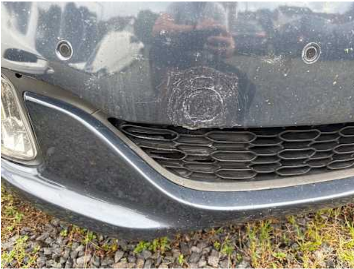
Stoßstange vorne (Unsachgemäß instand gesetzt)
