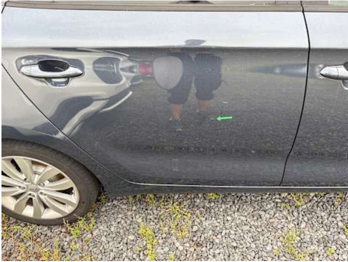
Türe hinten rechts (Unsachgemäß instand gesetzt)
