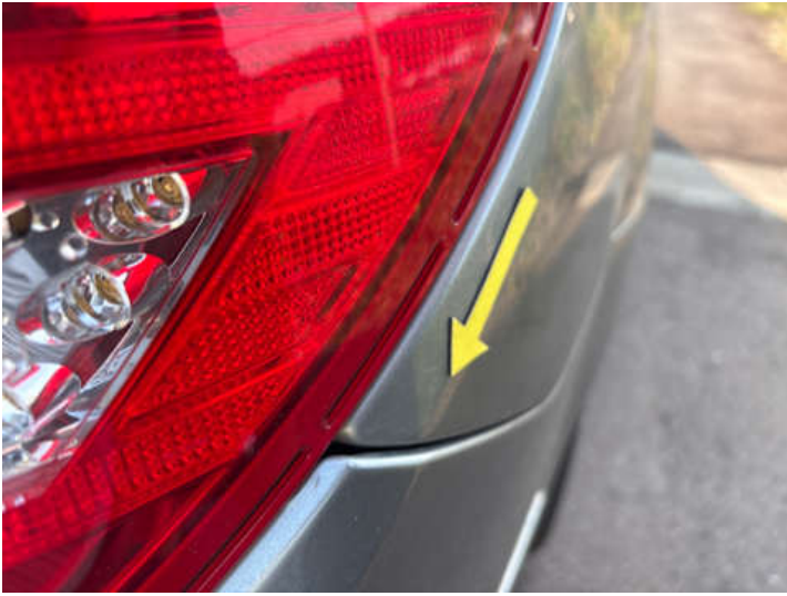
Stoßstange hinten (Spaltmaße ungenau)
