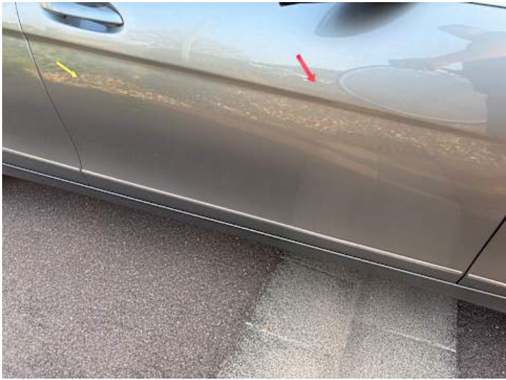
Beifahrertür (Lackschaden, Kratzer)
