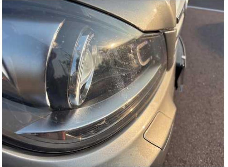
Scheinwerfer (rechts) (Steinschlag)
