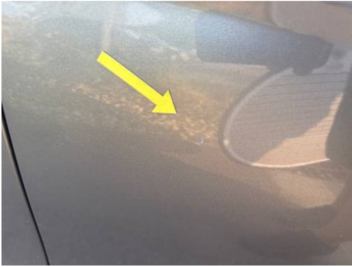
Beifahrertür (Lackschaden, Kratzer)
