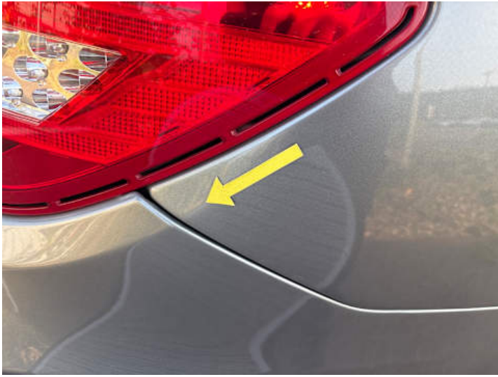
Stoßstange hinten (Spaltmaße ungenau)
