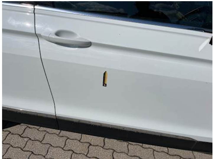
Beifahrertür (Delle, Kratzer)
