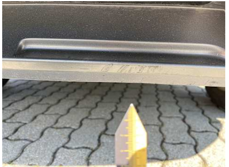
Stoßstange hinten (Kratzer, Delle)
