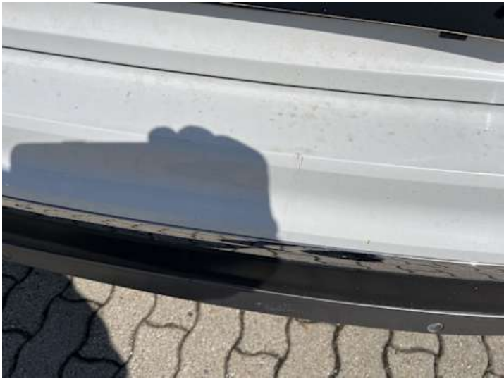
Stoßstange hinten (Kratzer, Delle)
