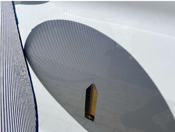
Beifahrertür (Delle, Kratzer)
