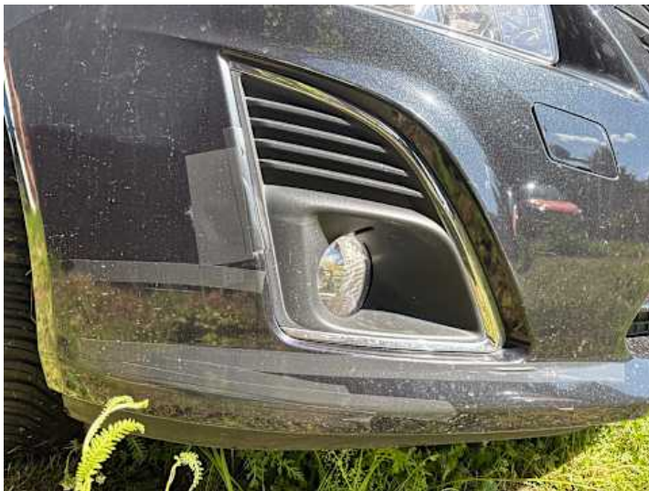
Stoßstange vorne (Kratzer, Lackschaden, Unsachgemäß instand gesetzt)
