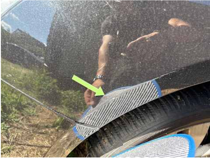
Kotflügel vorne links (Kratzer, Delle)
