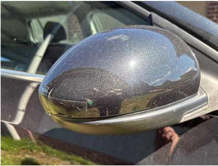
Beifahrertür (Kratzer, Unsachgemäß instand gesetzt, Lackschaden)
