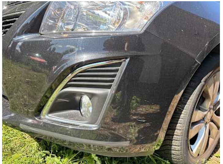
Stoßstange vorne (Kratzer, Lackschaden, Unsachgemäß instand gesetzt)
