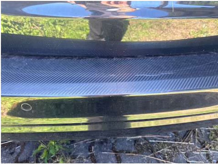
Stoßstange hinten (Kratzer, Riss/Bruch)
