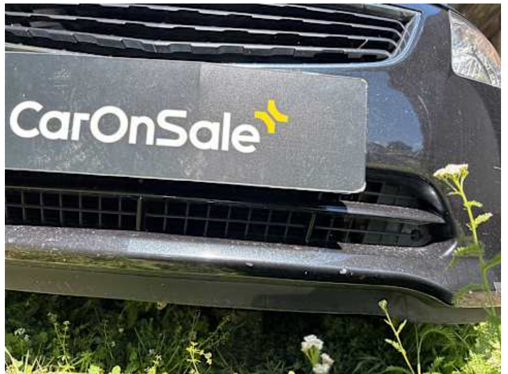
Stoßstange vorne (Kratzer, Lackschaden, Unsachgemäß instand gesetzt)
