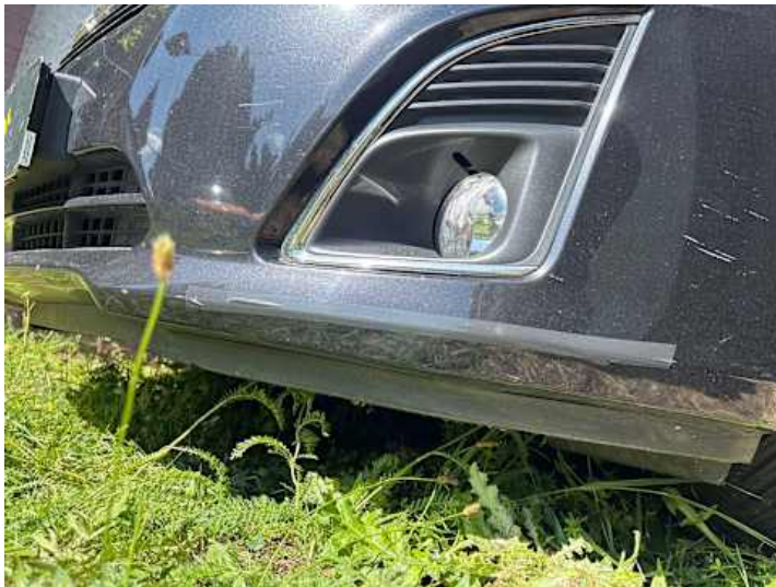
Stoßstange vorne (Kratzer, Lackschaden, Unsachgemäß instand gesetzt)
