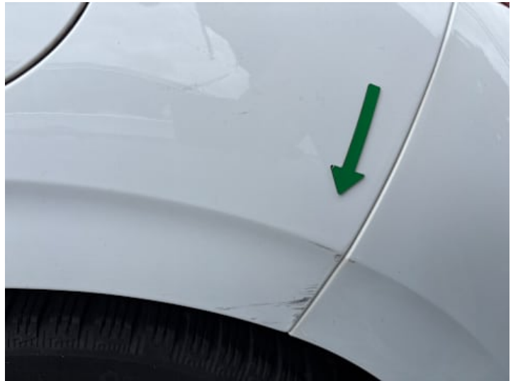
Seitenteil hinten links (Kratzer, Verformung)
