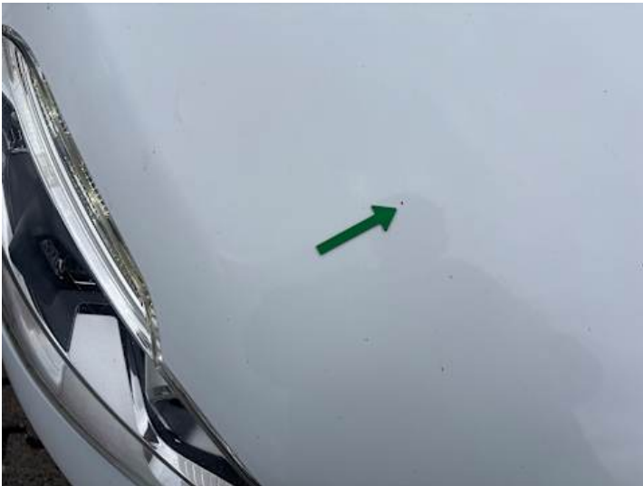
Motorhaube (Rost, Steinschlag)
