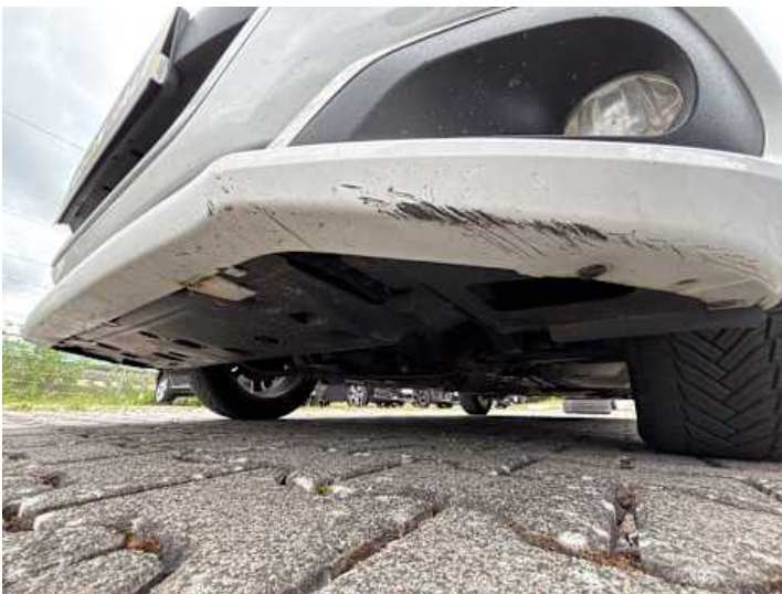
Stoßstange vorne (Kratzer)
