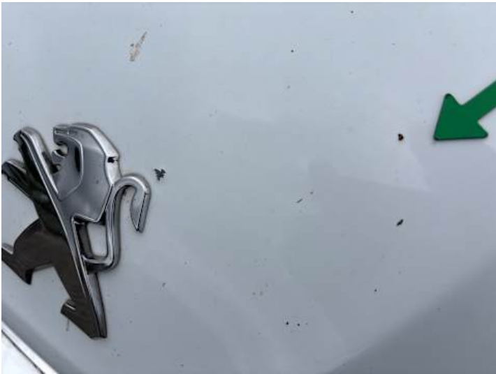
Motorhaube (Rost, Steinschlag)
