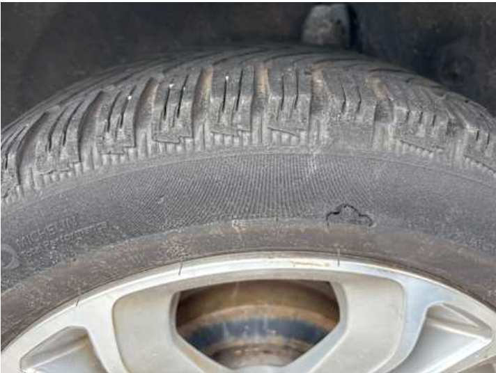
Rad (Anderer Schaden): Reifenflanke beschädigt
