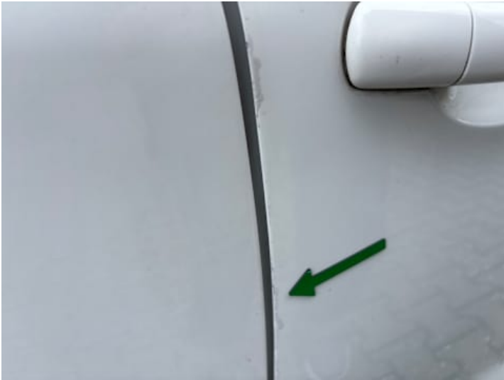
Beifahrertür (Unsachgemäß instand gesetzt)
