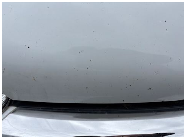
Motorhaube (Rost, Steinschlag)
