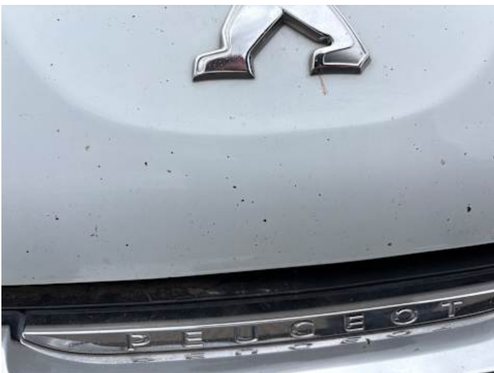
Motorhaube (Rost, Steinschlag)
