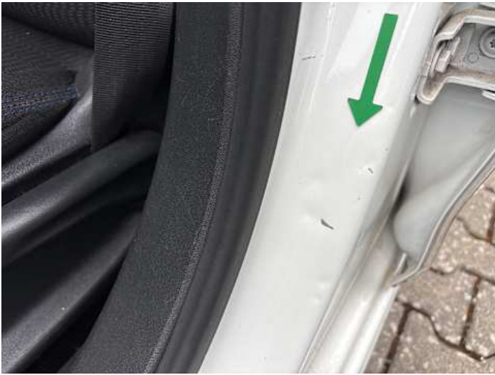
Schweller links (Kratzer, Delle)
