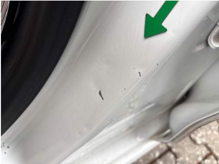
Schweller links (Kratzer, Delle)
