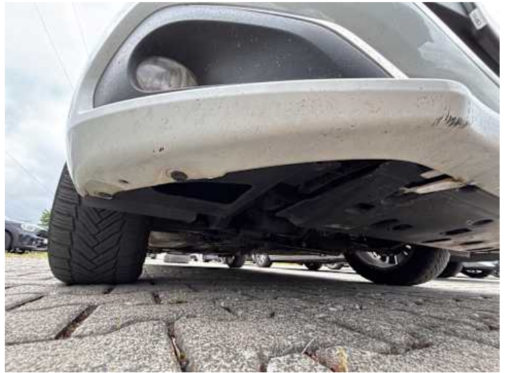
Stoßstange vorne (Kratzer)
