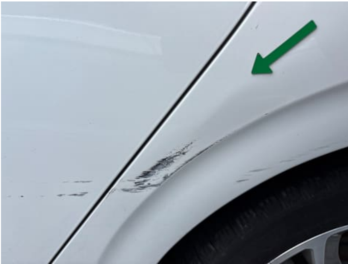
Seitenteil hinten links (Kratzer, Verformung)
