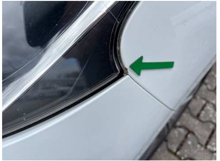
Kotflügel vorne links (Rost)
