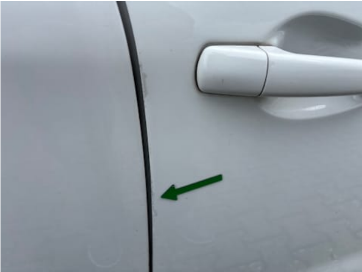
Beifahrertür (Unsachgemäß instand gesetzt)
