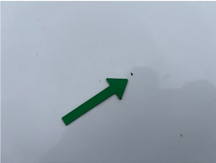
Motorhaube (Rost, Steinschlag)
