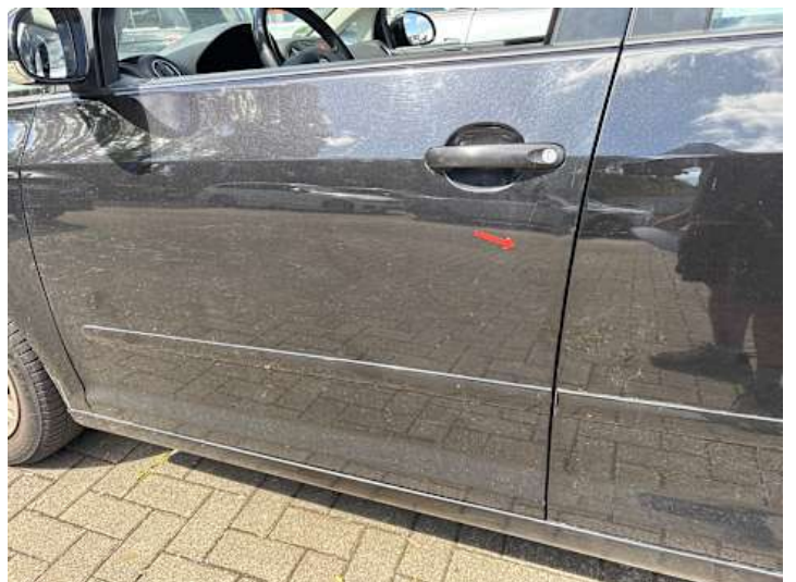
Fahrtür (Verformung, Delle)
