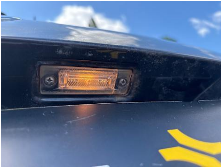
Heckklappe (Rost, Lackschaden, Kratzer)
