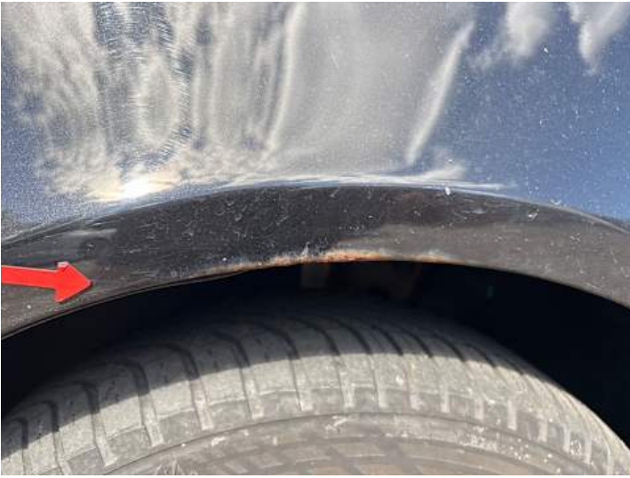
Kotflügel vorne links (Rost)
