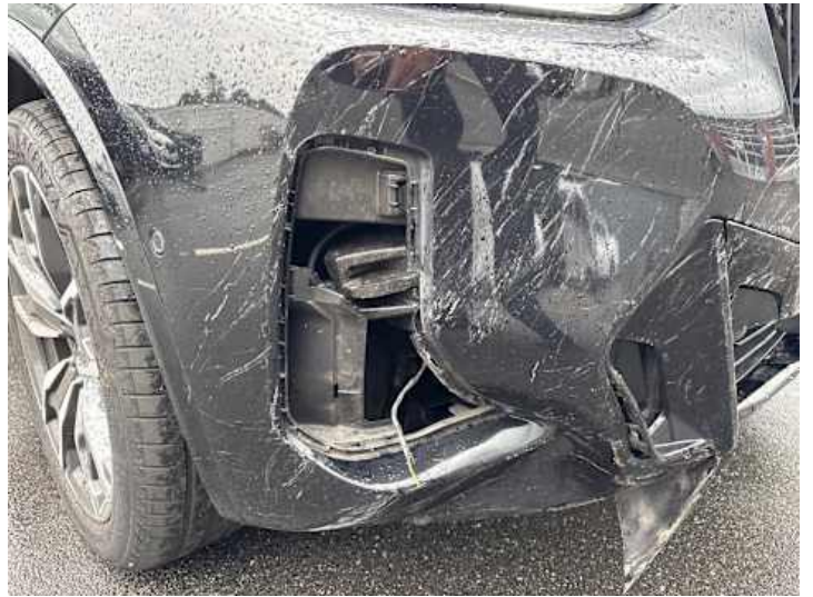
Stoßstange vorne (Riss/Bruch, Kratzer, Lackschaden)
