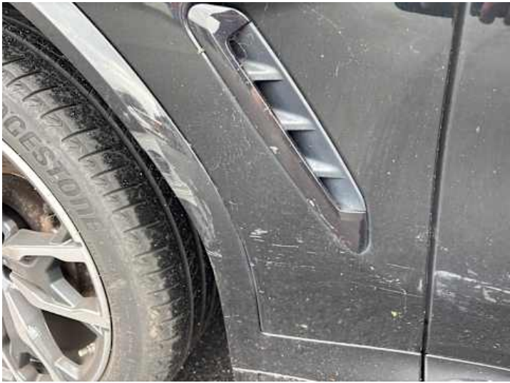
Kotflügel vorne links (Kratzer)
