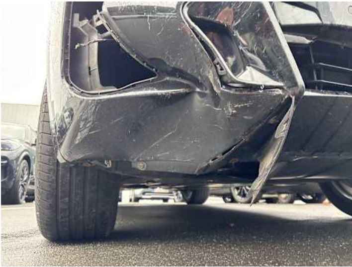
Stoßstange vorne (Riss/Bruch, Kratzer, Lackschaden)
