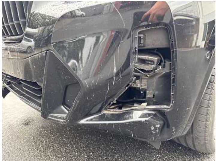
Stoßstange vorne (Riss/Bruch, Kratzer, Lackschaden)
