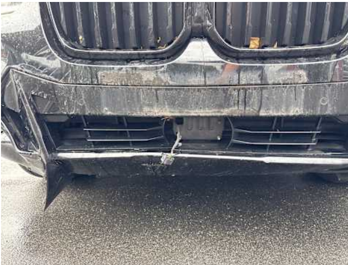
Stoßstange vorne (Riss/Bruch, Kratzer, Lackschaden)
