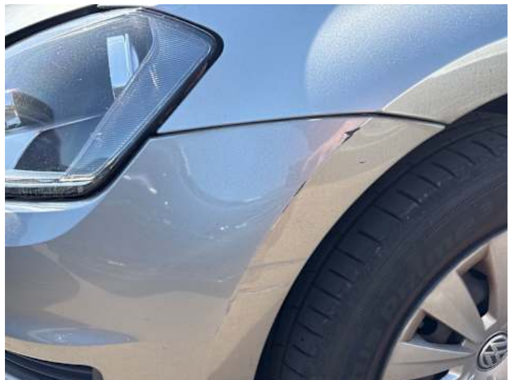
Stoßstange vorne (Riss/Bruch, Kratzer)
