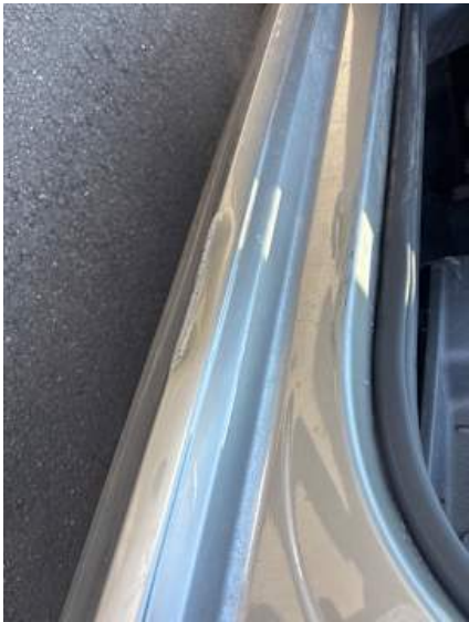
Schweller links (Verformung)
