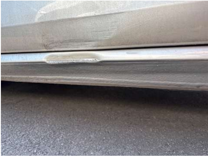
Schweller links (Verformung)
