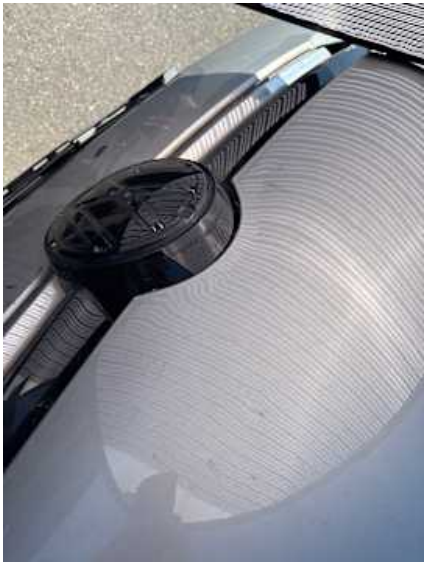
Motorhaube (Kratzer, Delle)
