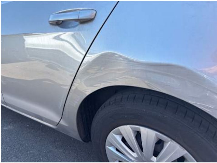
Seitenteil hinten links (Kratzer, Verformung, Delle)
