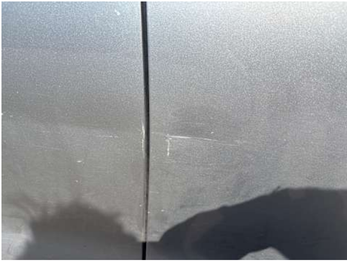
Beifahrertür (Kratzer, Delle)
