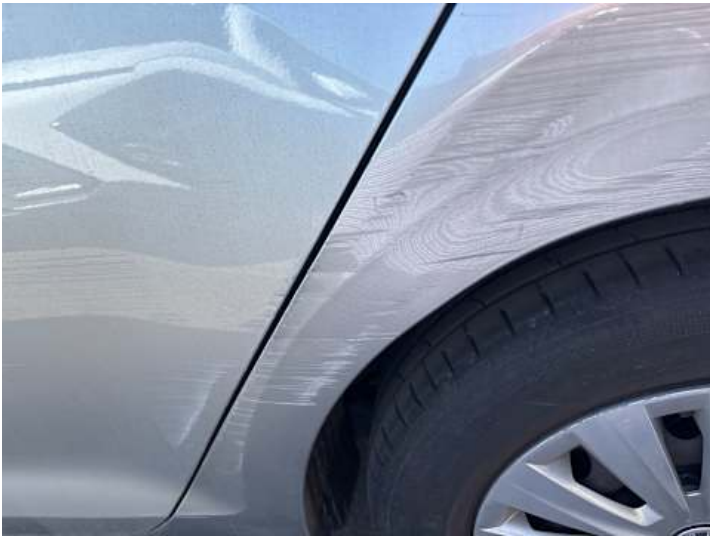
Seitenteil hinten links (Kratzer, Verformung, Delle)
