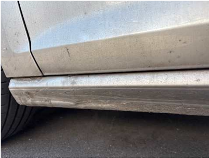
Schweller links (Verformung)
