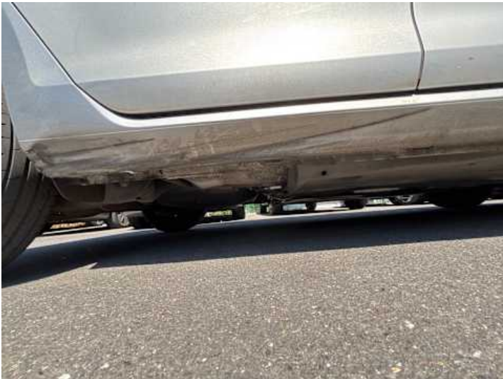
Schweller rechts (Verformung)
