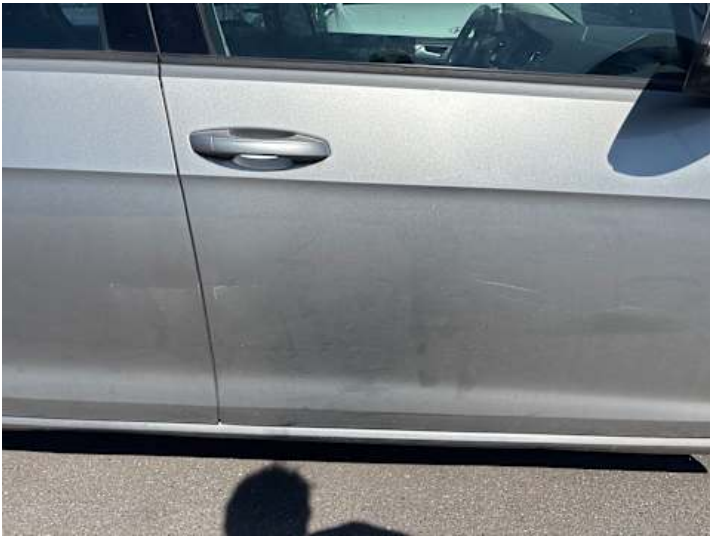
Beifahrertür (Kratzer, Delle)
