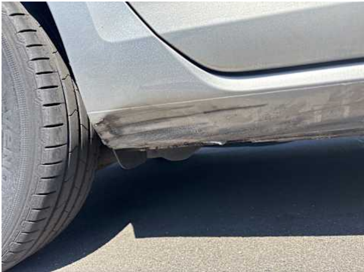
Schweller rechts (Verformung)
