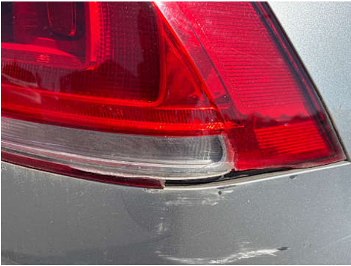
Rücklicht (rechts) (Riss/Bruch)
