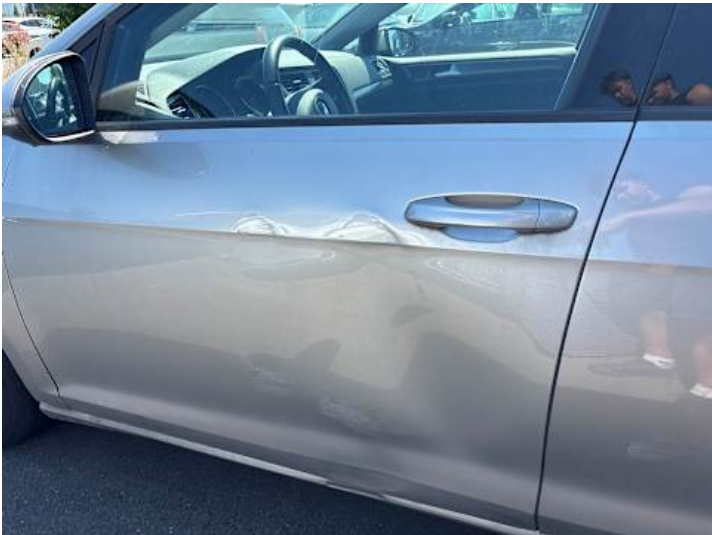
Fahrtür (Verformung, Kratzer, Delle)
