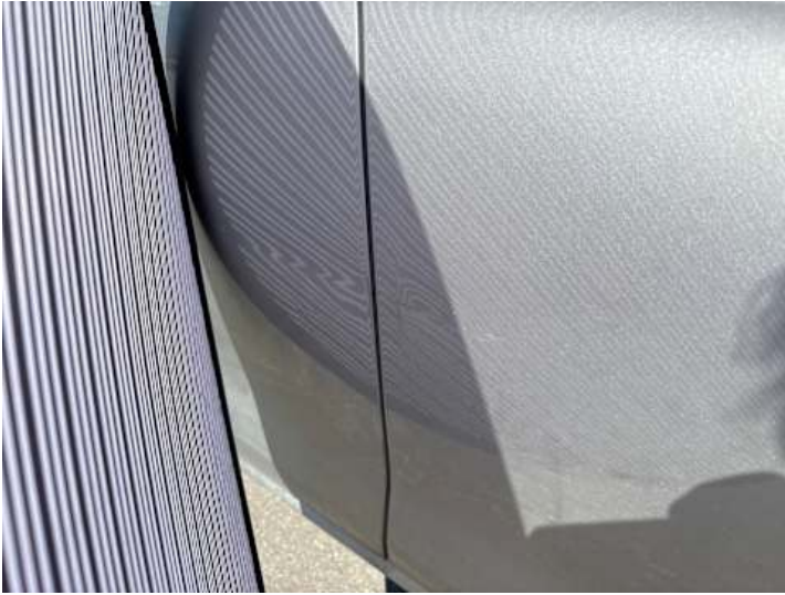
Beifahrertür (Kratzer, Delle)
