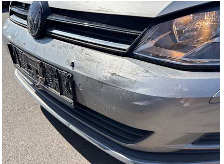
Stoßstange vorne (Riss/Bruch, Kratzer)
