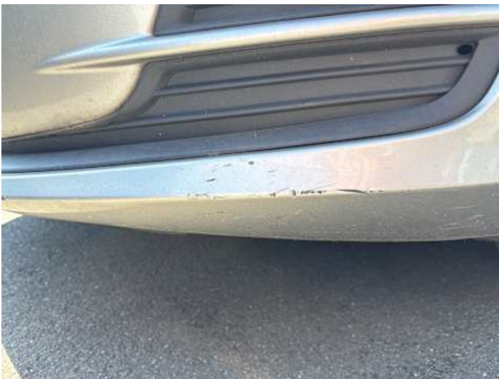
Stoßstange vorne (Riss/Bruch, Kratzer)
