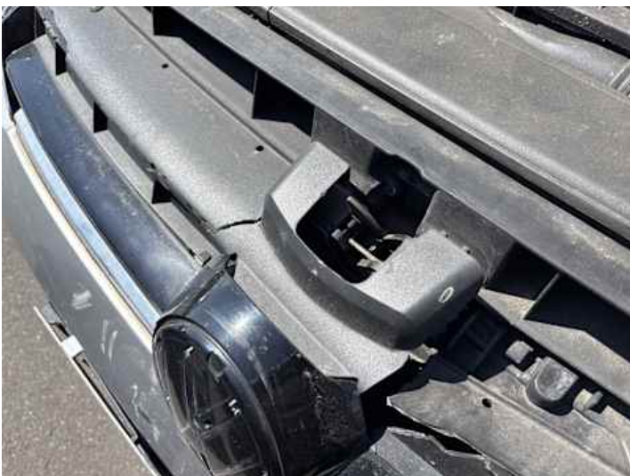
Stoßstange vorne (Riss/Bruch, Kratzer)
