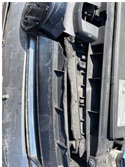
Stoßstange vorne (Riss/Bruch, Kratzer)
