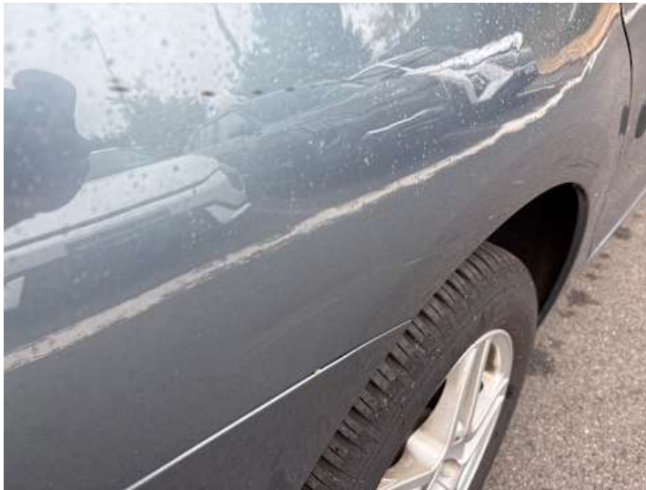
Türe hinten rechts (Kratzer, Delle)
