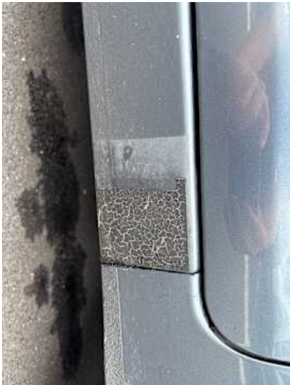
Schweller rechts (Unsachgemäß instand gesetzt)
