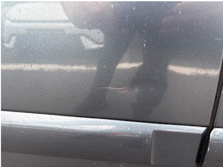
Türe hinten rechts (Kratzer, Delle)
