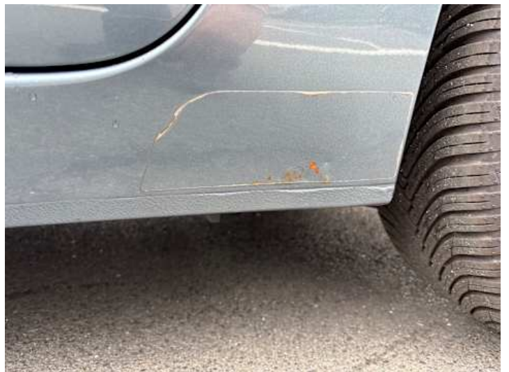
Schweller links (Rost)
