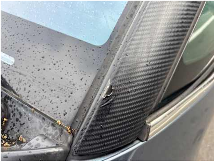
Kotflügel vorne links (Spaltmaße ungenau, Kratzer)
