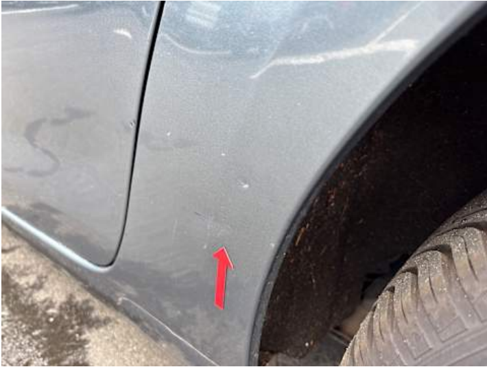
Seitenteil hinten links (Kratzer, Delle)
