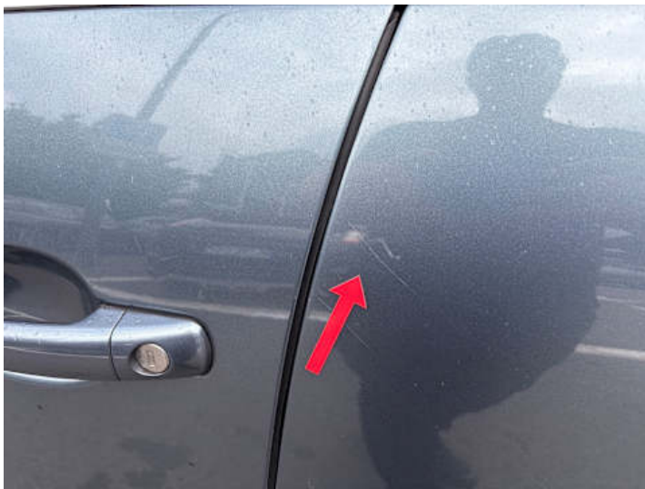
Türe hinten links (Kratzer)
