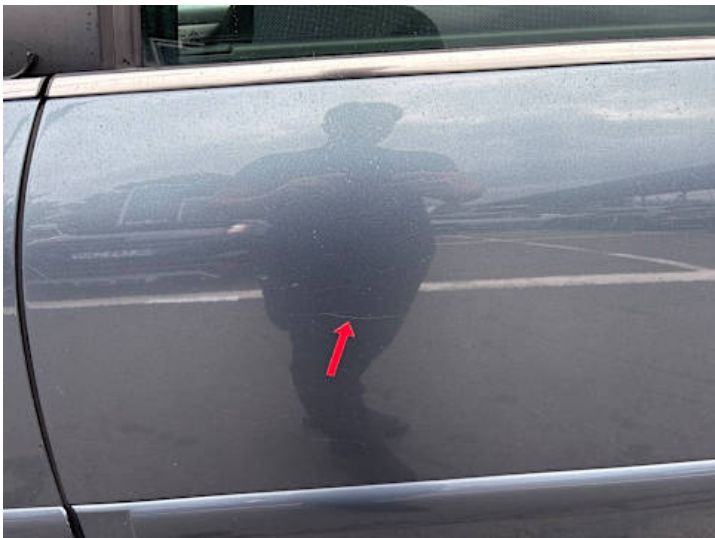
Türe hinten links (Kratzer)
