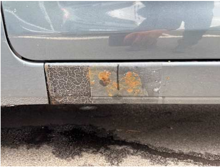
Schweller links (Rost)
