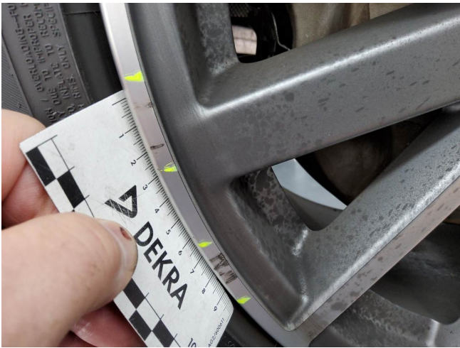
Alufelge Sommerrad vorne rechts verschrammt, Minderwert (DEKRA)
