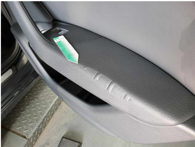
Abdeckungen Zuziehgriffe Türverkleidungen hinten deformiert (bedingt durch Radsatz im Fahrzeug) ..
