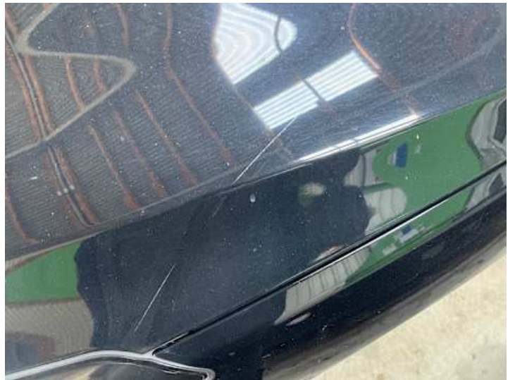
Motorhaube (Kratzer, Lackschaden)
