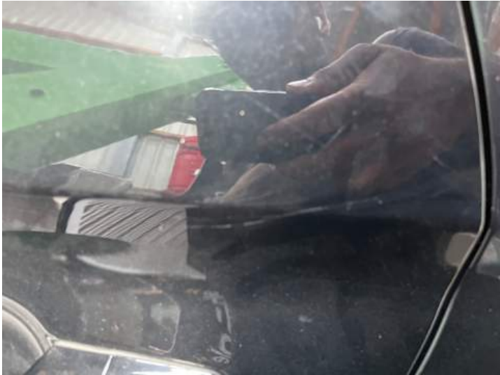
Türe hinten links (Lackschaden, Kratzer)
