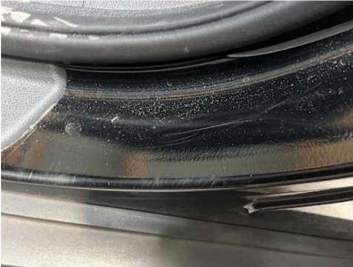
Fahrtür (Kratzer, Lackschaden)
