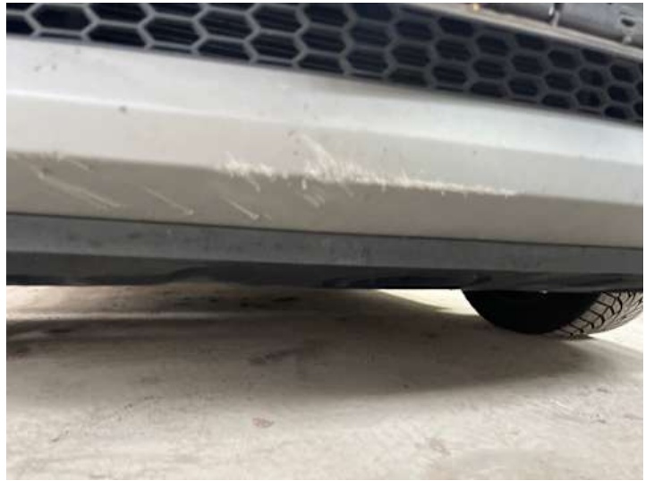
Stoßstange vorne (Kratzer, Verformung)
