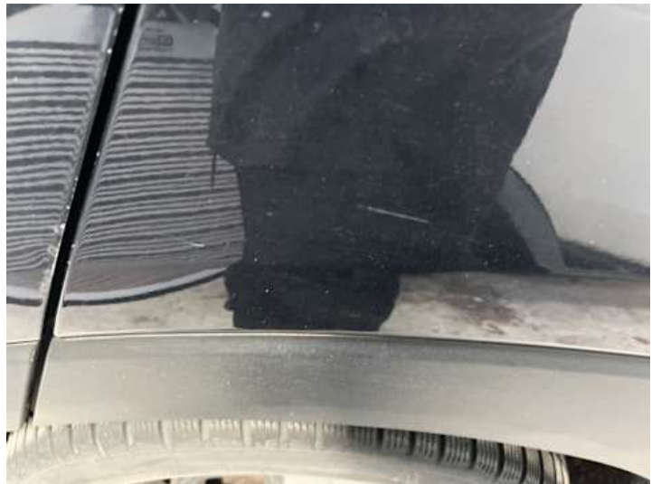
Seitenteil hinten links (Kratzer, Lackschaden)
