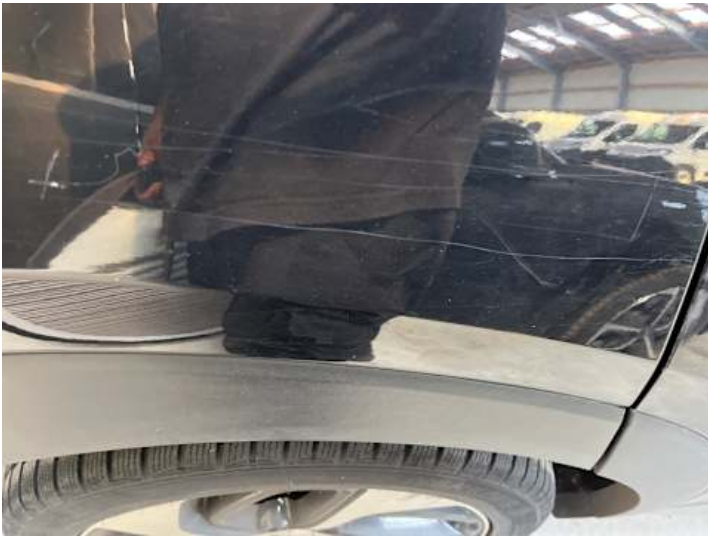
Seitenteil hinten rechts (Kratzer, Lackschaden)
