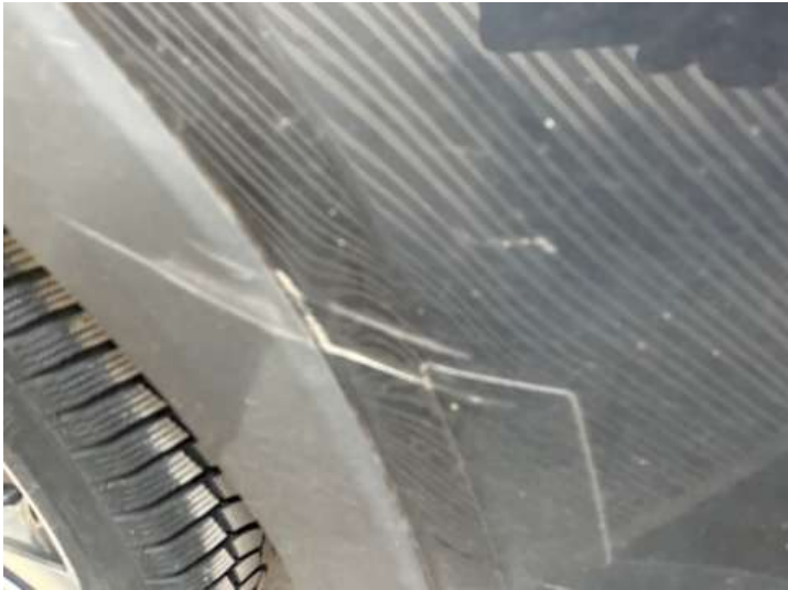
Türe hinten rechts (Verformung)
