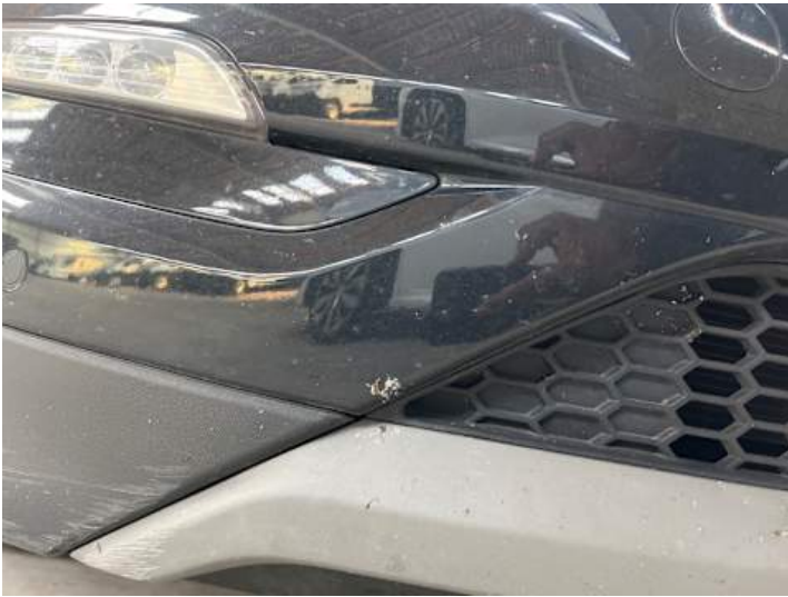
Stoßstange vorne (Lackschaden)
