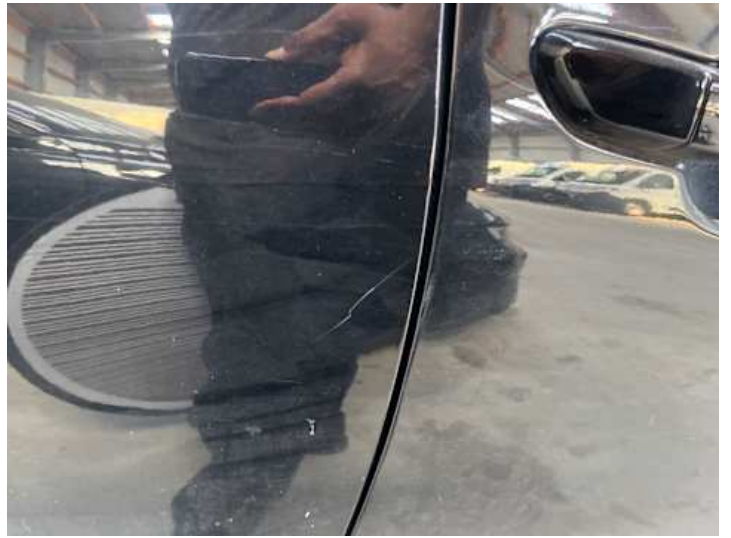
Türe hinten rechts (Kratzer, Lackschaden)
