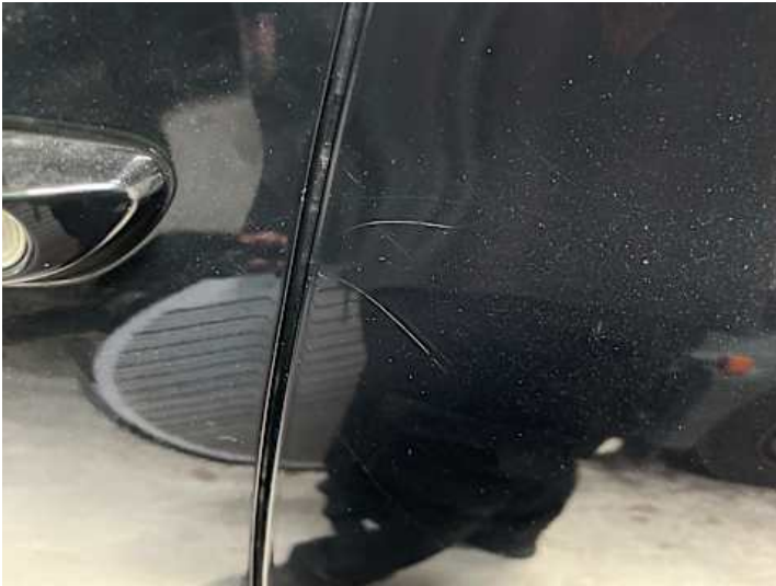
Türe hinten links (Lackschaden, Kratzer)
