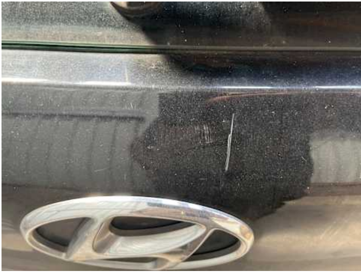
Heckklappe (Kratzer, Lackschaden)
