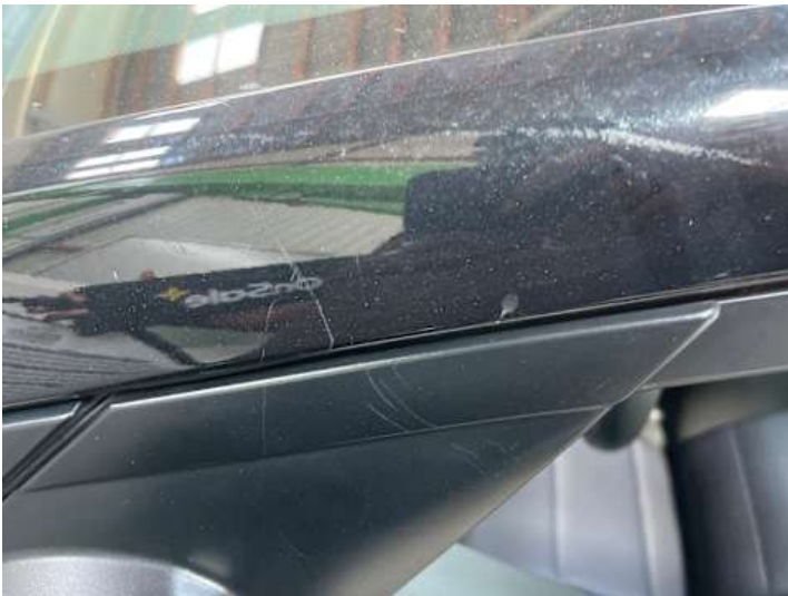
Seitenteil hinten links (Kratzer, Lackschaden)
