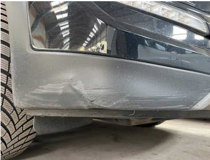
Stoßstange vorne (Kratzer, Verformung)
