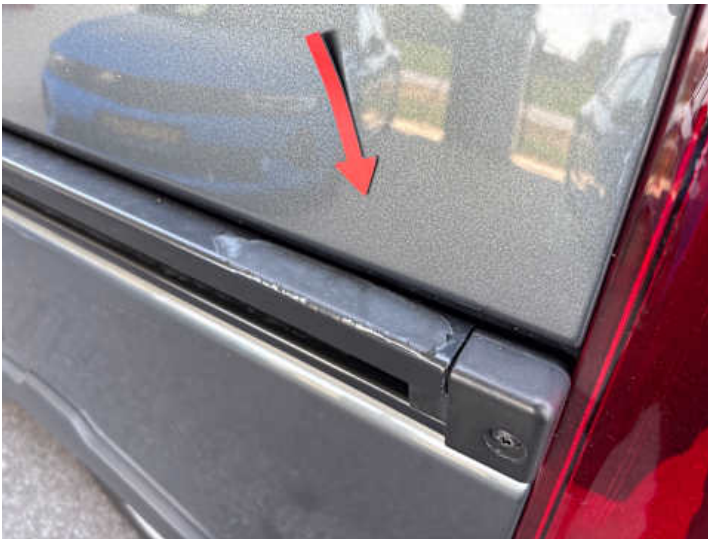
Seitenteil hinten links (Lackschaden)
