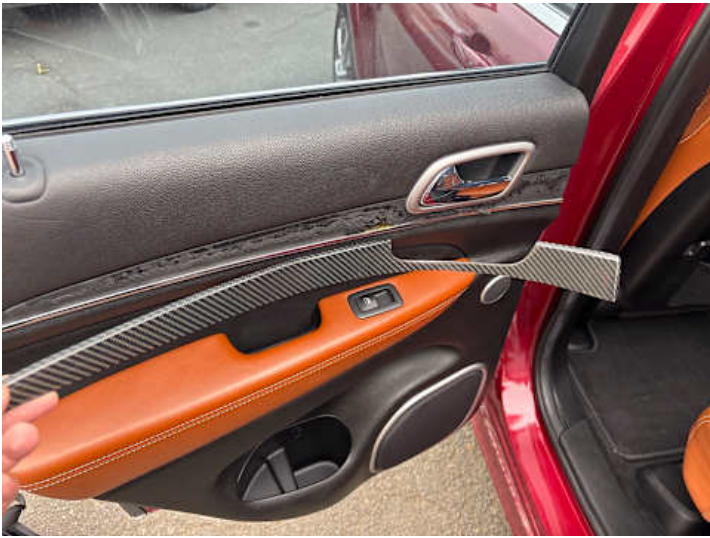
Innenraum (Riss/Bruch, Diverse Schäden)
