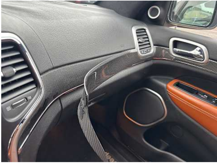
Innenraum (Riss/Bruch, Diverse Schäden)
