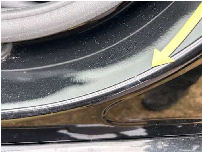
Schweller links (Lackschaden)
