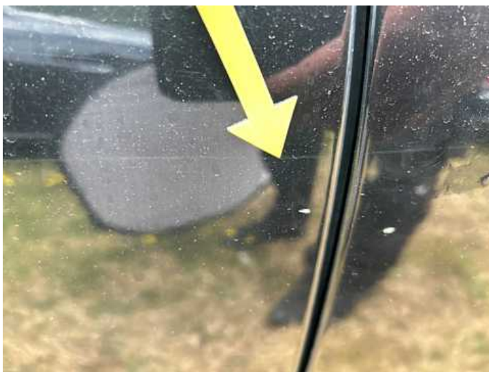
Beifahrertür (Lackschaden, Steinschlag)
