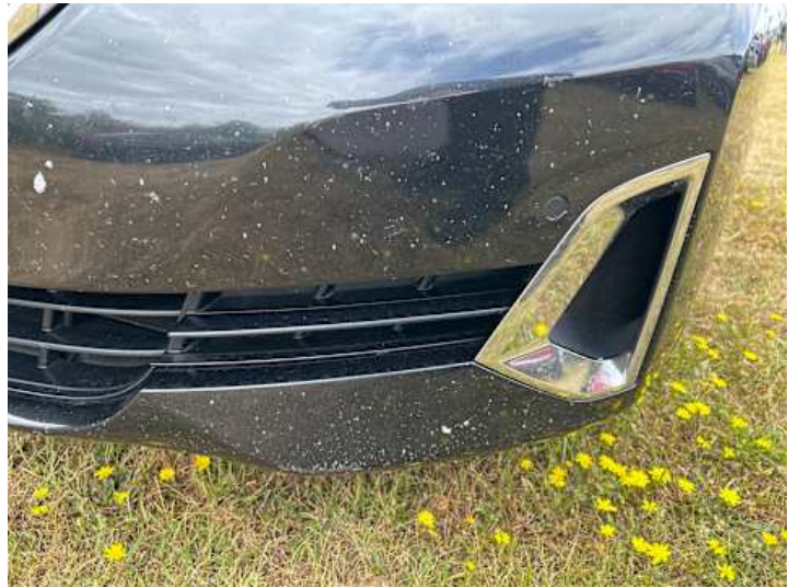
Stoßstange vorne (Lackschaden, Steinschlag)
