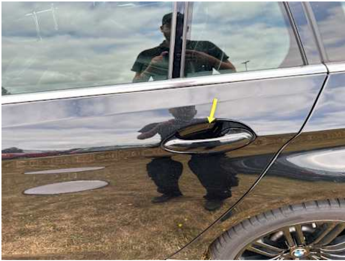
Türe hinten links (Kratzer)
