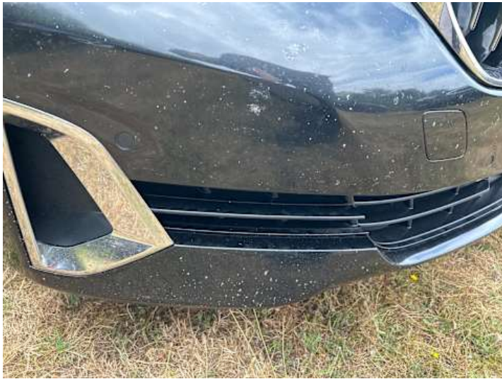
Stoßstange vorne (Lackschaden, Steinschlag)
