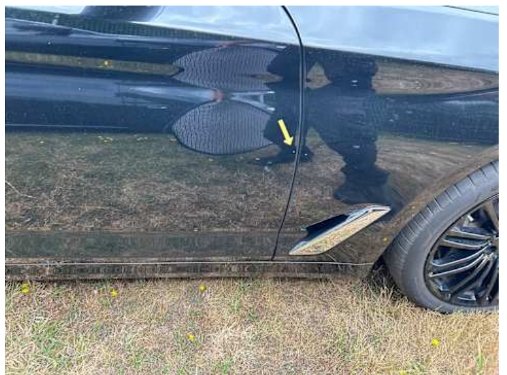
Beifahrertür (Lackschaden, Steinschlag)
