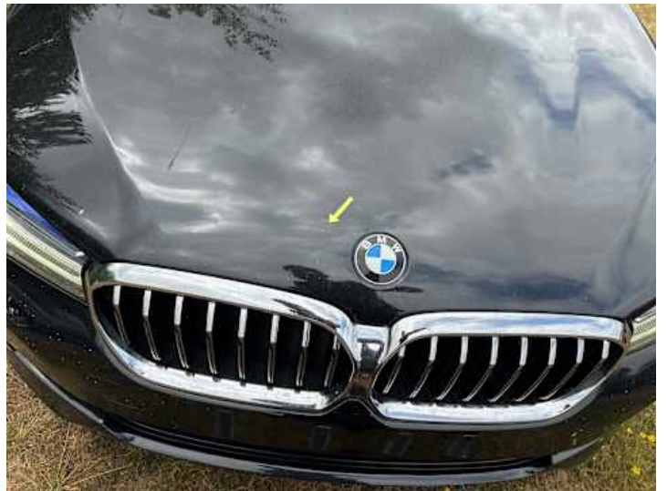
Motorhaube (Lackschaden, Steinschlag)
