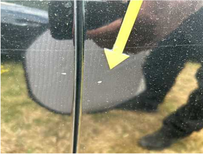
Kotflügel vorne rechts (Lackschaden, Steinschlag)
