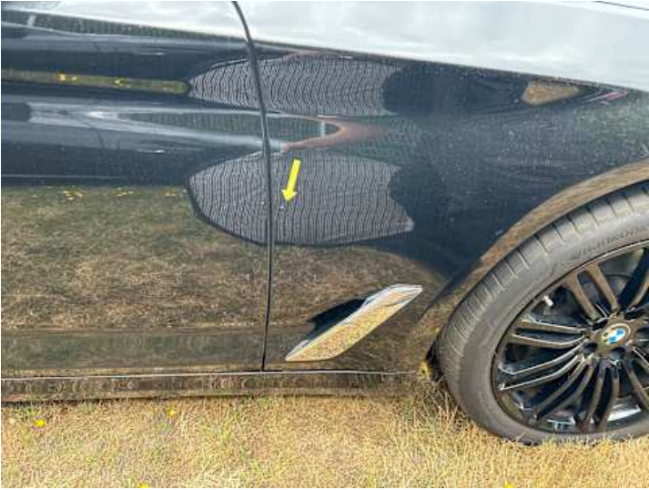
Kotflügel vorne rechts (Lackschaden, Steinschlag)
