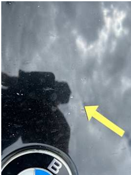
Motorhaube (Lackschaden, Steinschlag)
