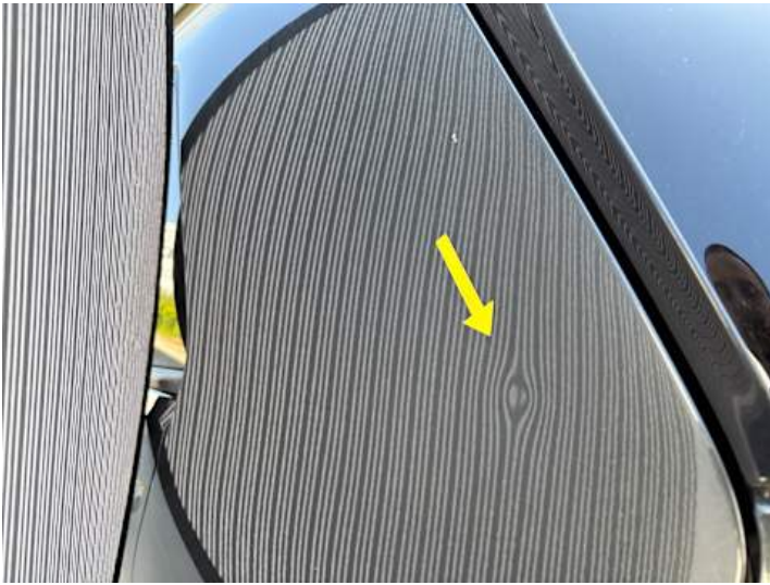
Seitenteil hinten links (Delle)
