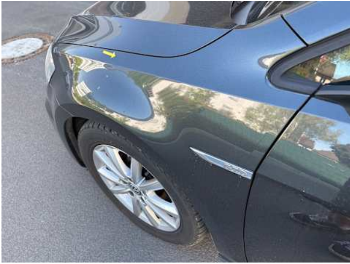
Kotflügel vorne links (Delle)
