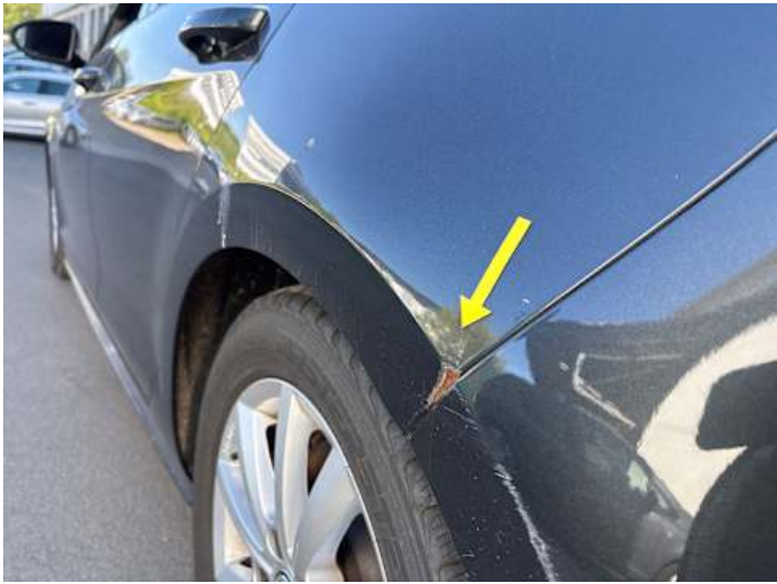
Seitenteil hinten links (Lackschaden, Rost)
