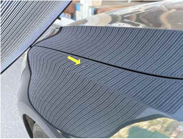
Kotflügel vorne links (Delle)
