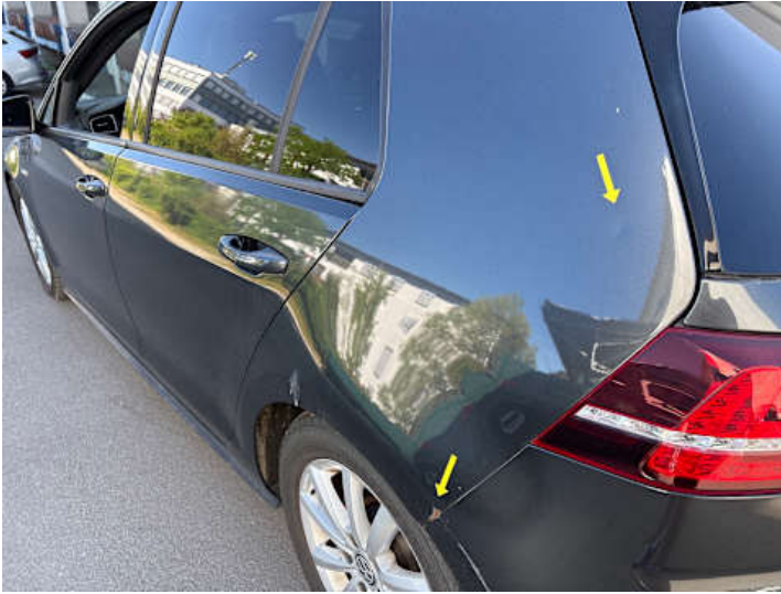
Seitenteil hinten links (Rost, Lackschaden, Delle)
