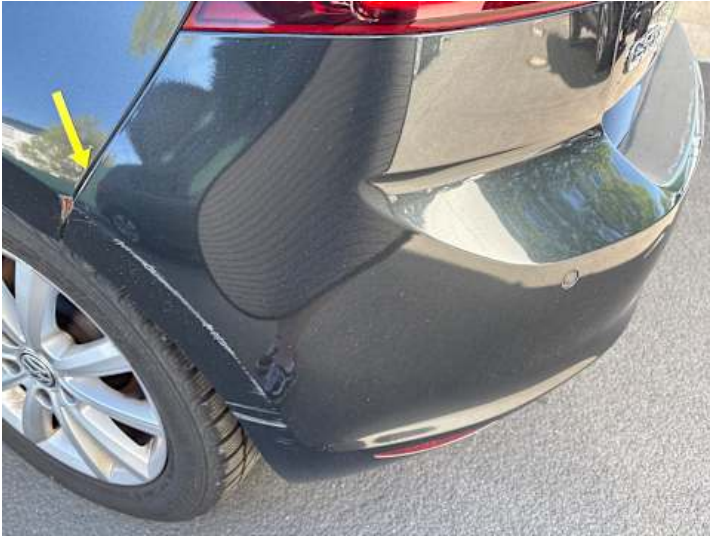
Stoßstange hinten (Kratzer, Lackschaden)
