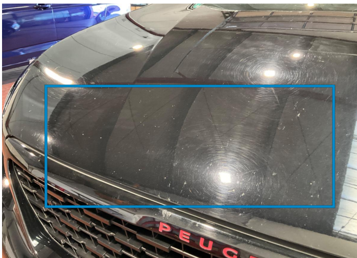
3. Haube / Vorn Lack / Steinschlag -
