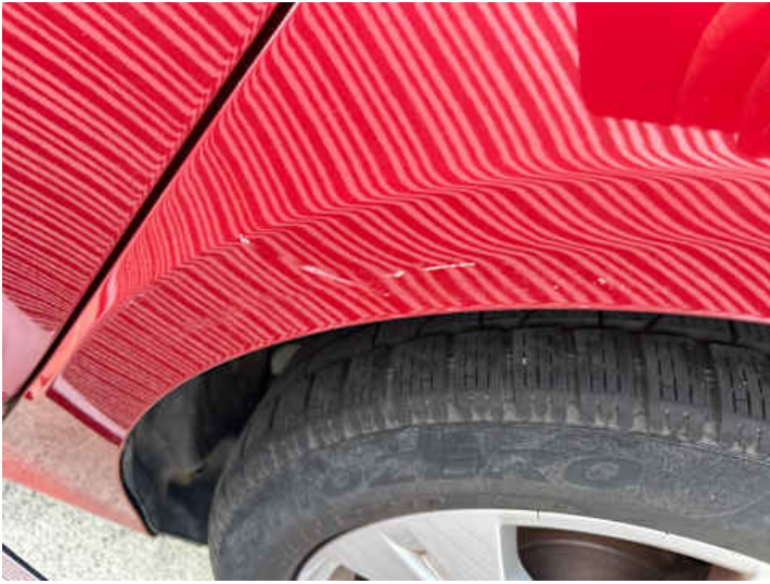
Seitenteil hinten links (Kratzer, Verformung)
