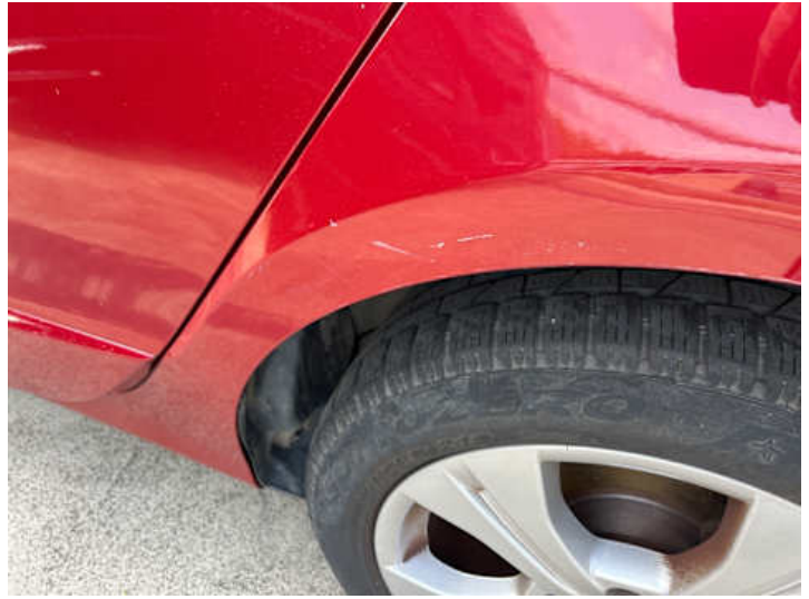
Seitenteil hinten links (Kratzer, Verformung)
