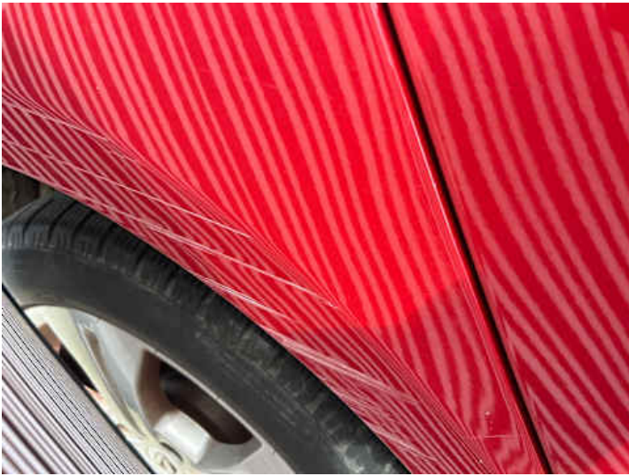
Seitenteil hinten rechts (Kratzer, Verformung)
