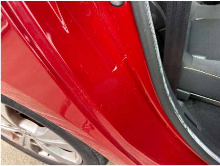
Schweller rechts (Kratzer, Delle)
