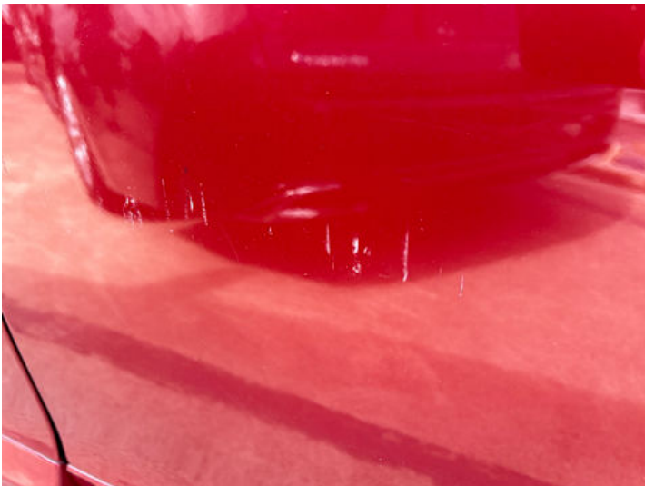
Türe hinten links (Kratzer)
