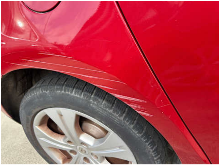
Seitenteil hinten rechts (Kratzer, Verformung)
