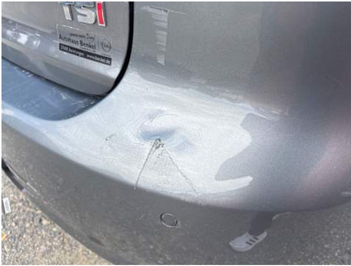
Stoßstange hinten (Kratzer, Riss/Bruch, Delle)
