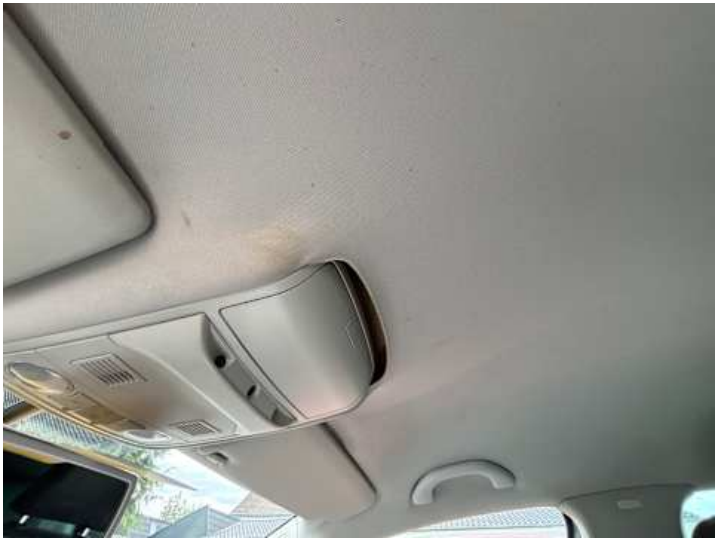
Innenraum (Anderer Schaden): Stoffablösung
