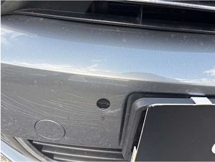
Stoßstange vorne (Kratzer, Riss/Bruch, Anderer Schaden): Ein Sensor beschädigt
