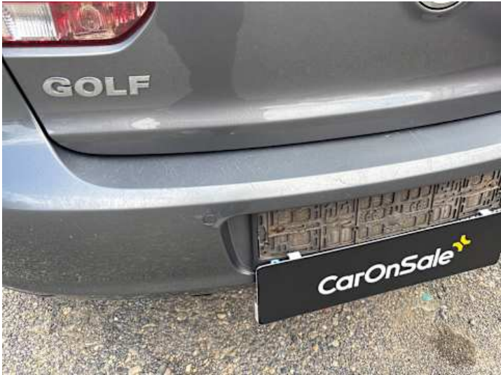
Stoßstange hinten (Kratzer, Riss/Bruch, Delle)
