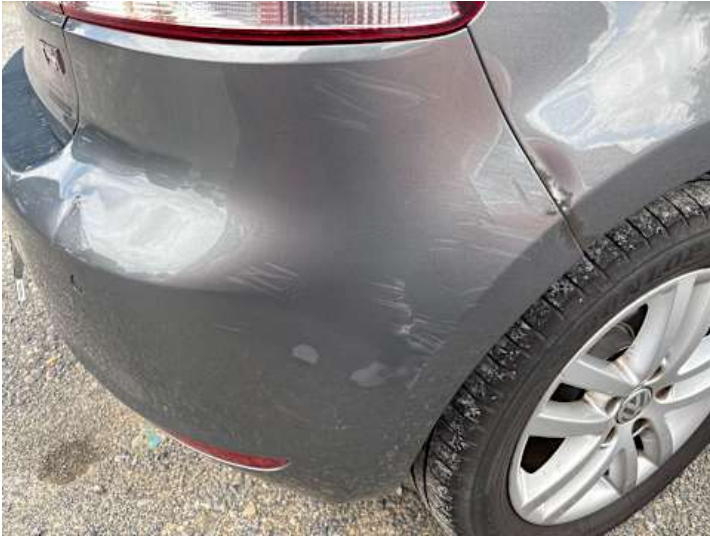
Stoßstange hinten (Kratzer, Riss/Bruch, Delle)
