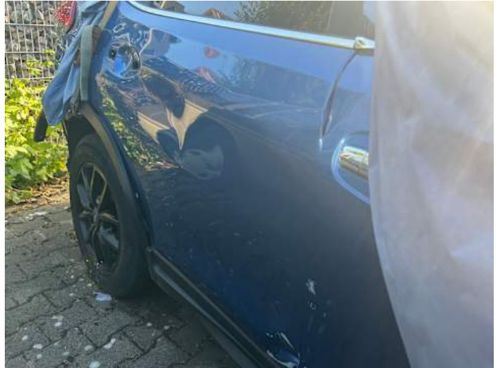
Türe hinten rechts (Verformung, Lackschaden, Riss/Bruch)
