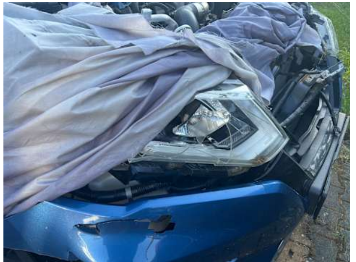
Scheinwerfer (rechts) (Riss/Bruch)
