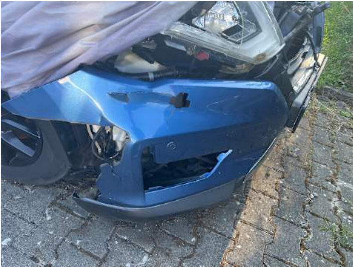
Stoßstange vorne (Riss/Bruch)
