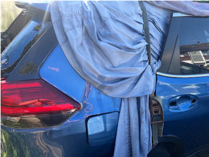
Seitenteil hinten rechts (Verformung, Lackschaden, Riss/Bruch)
