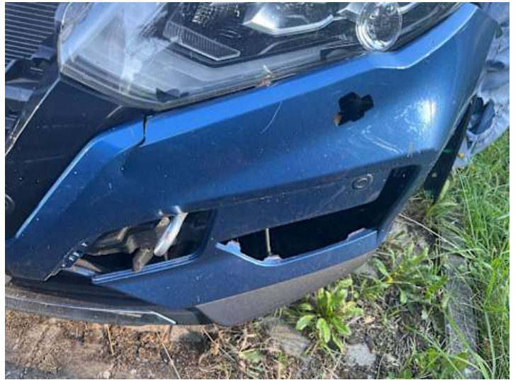
Stoßstange vorne (Riss/Bruch)
