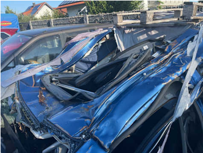
Dach (Verformung, Lackschaden, Riss/Bruch)
