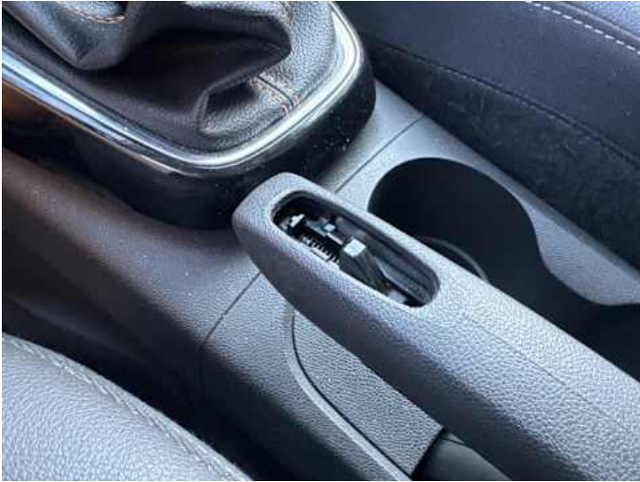
Innenraum (Anderer Schaden): Handbremse Hebel defekt
