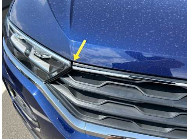
Stoßstange vorne (Spaltmaße ungenau)
