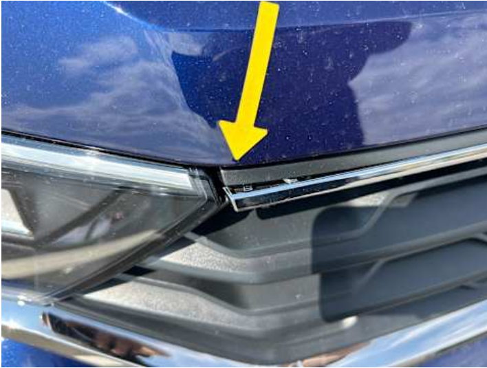
Stoßstange vorne (Spaltmaße ungenau)
