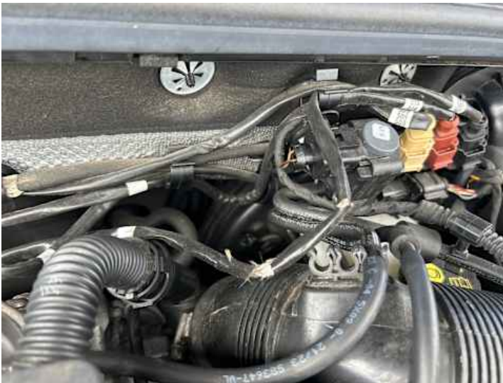
Motorhaube (Anderer Schaden): Tierbissspuren
