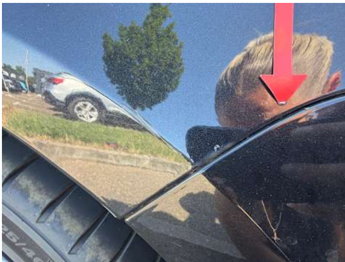
Seitenteil hinten links (Rost)
