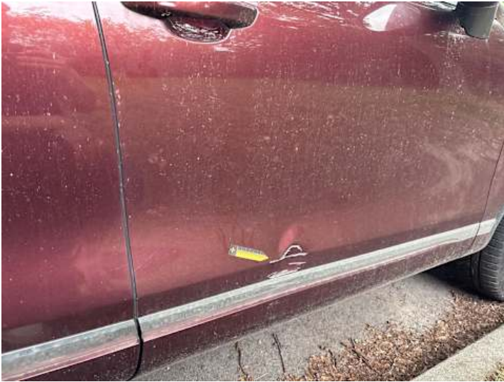
Beifahrtür (Kratzer, Lackschaden, Verformung)
