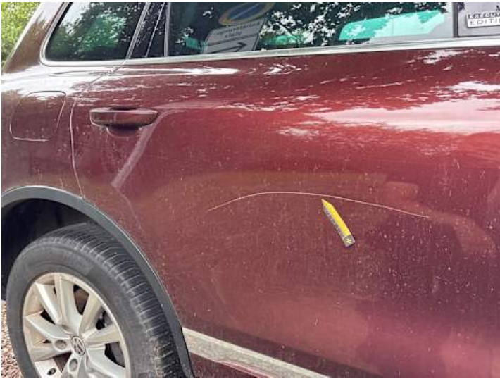
Türe hinten rechts (Kratzer, Lackschaden)
