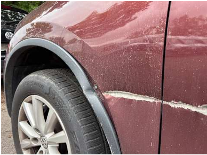
Kotflügel vorne links (Kratzer, Lackschaden, Verformung)
