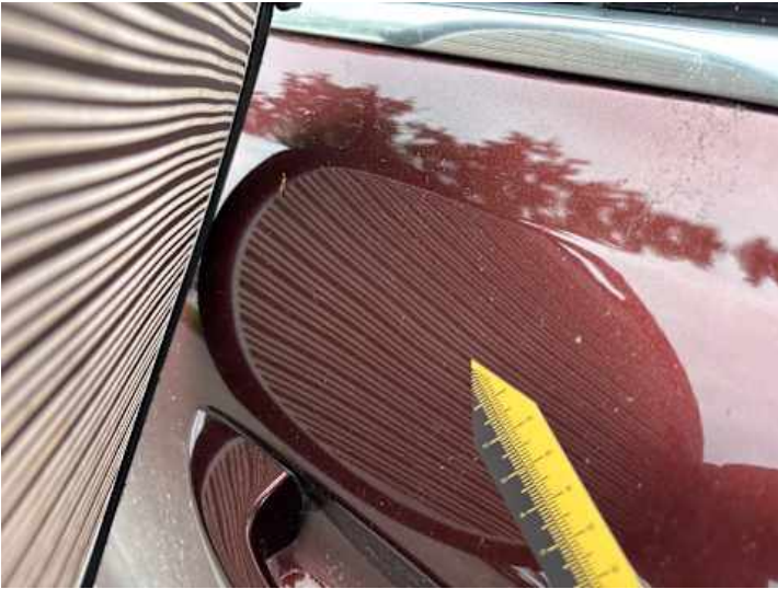
Türe hinten links (Delle)
