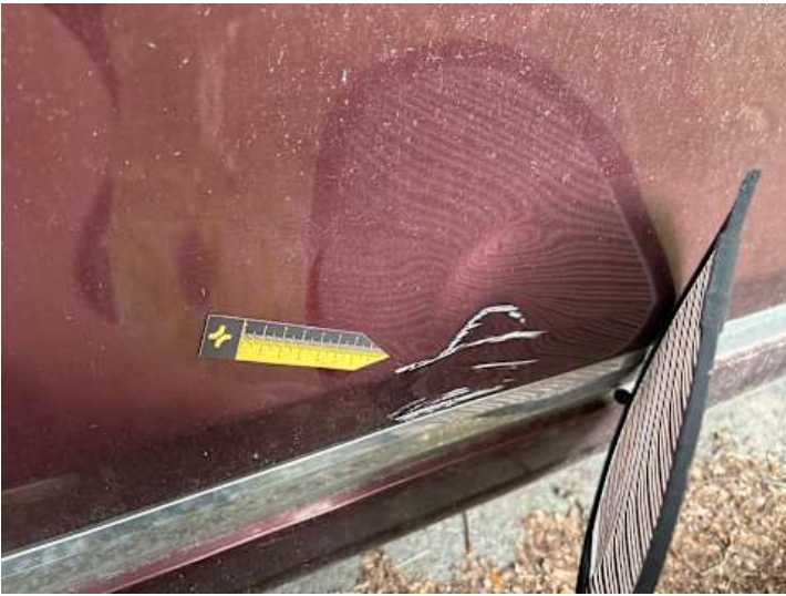
Beifahrtür (Kratzer, Lackschaden, Verformung)
