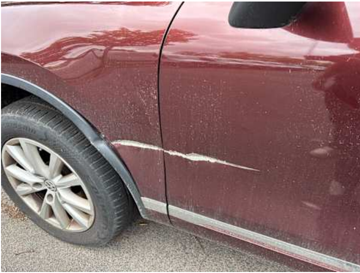
Fahrtür (Kratzer, Lackschaden, Verformung, Spaltmaße ungenau)
