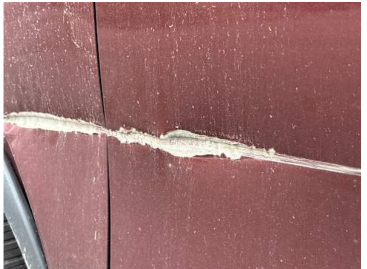
Fahrtür (Kratzer, Lackschaden, Verformung, Spaltmaße ungenau)
