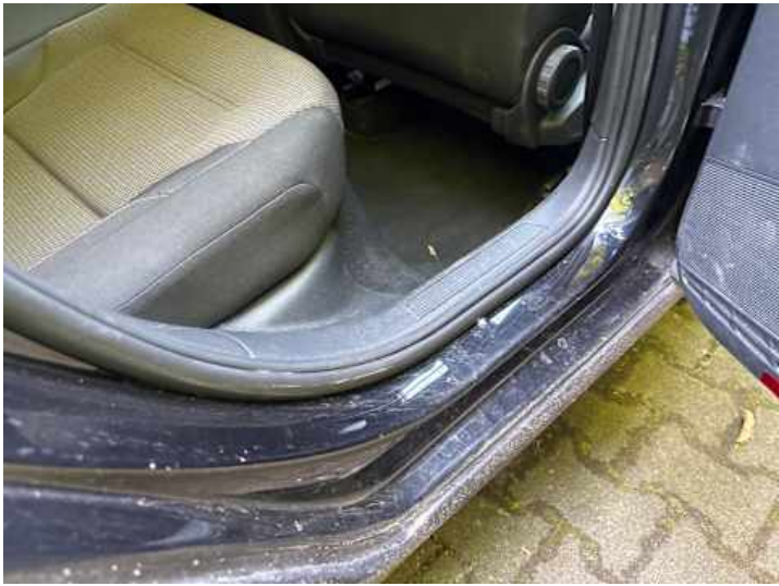
Türe hinten rechts (Kratzer)
