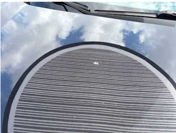
Motorhaube (Steinschlag, Delle)
