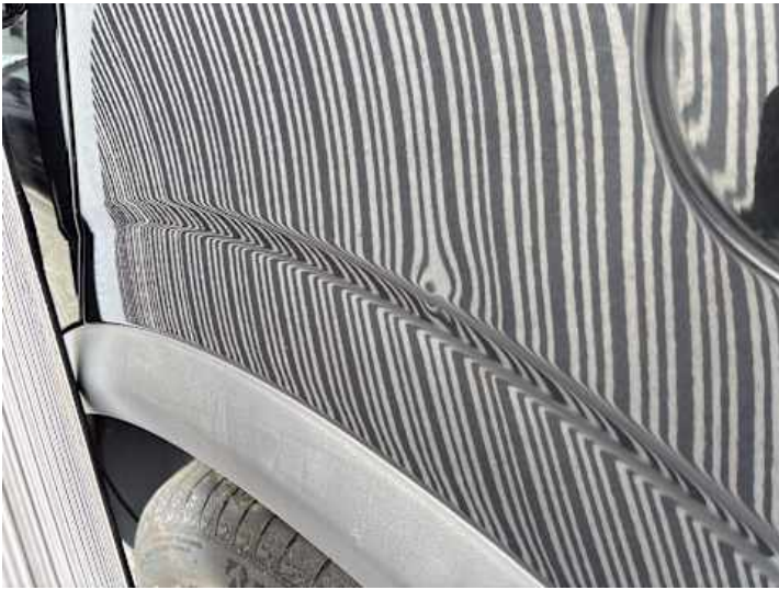
Seitenteil hinten links (Kratzer, Delle)
