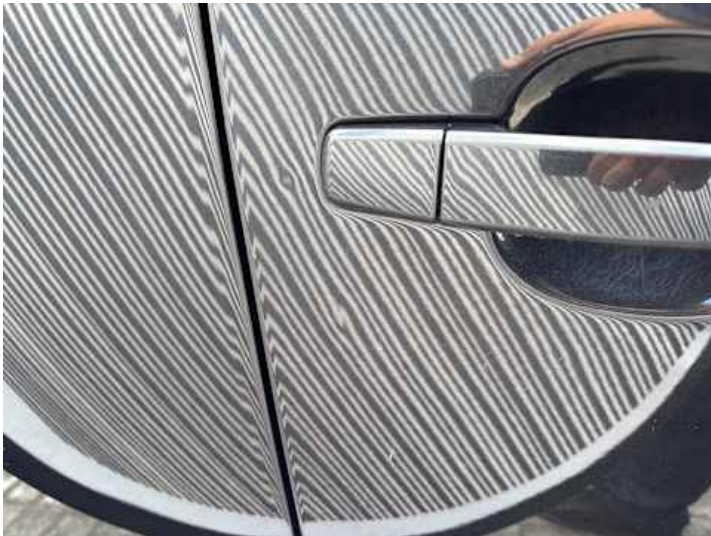
Beifahrtür (Kratzer, Delle)
