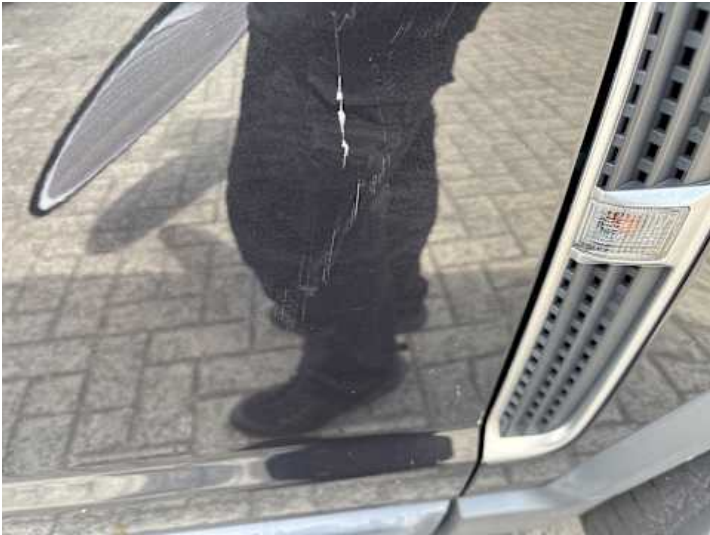
Beifahrtür (Kratzer, Delle)
