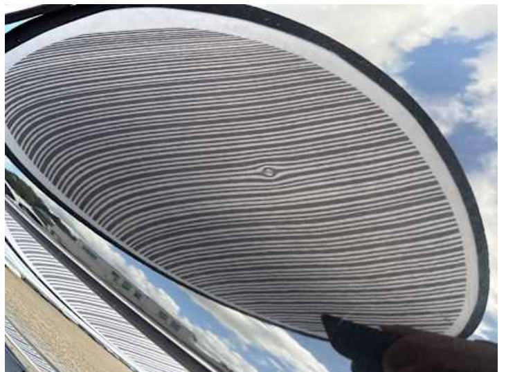
Motorhaube (Steinschlag, Delle)
