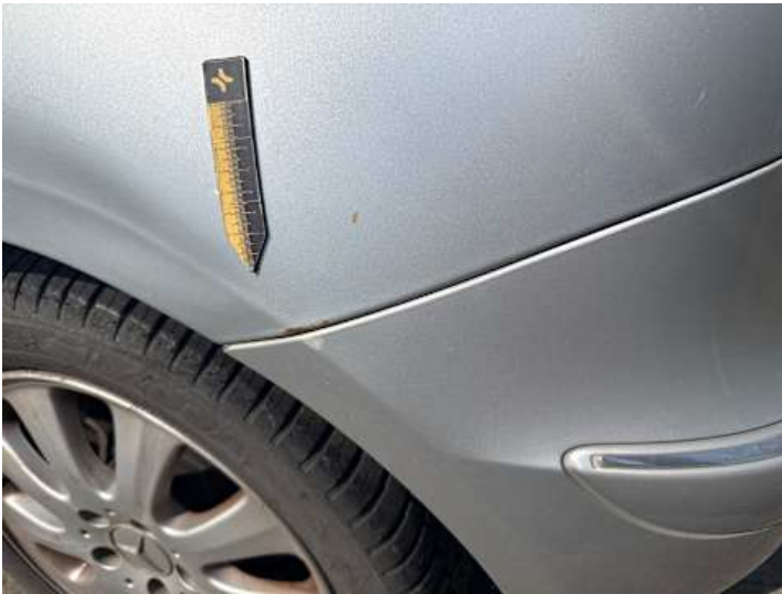
Seitenteil hinten links (Rost)
