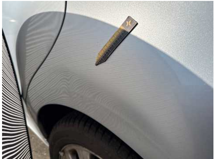
Seitenteil hinten links (Verformung)
