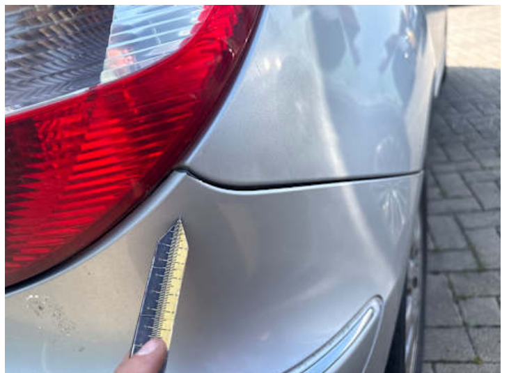
Stoßstange hinten (Lackschaden)
