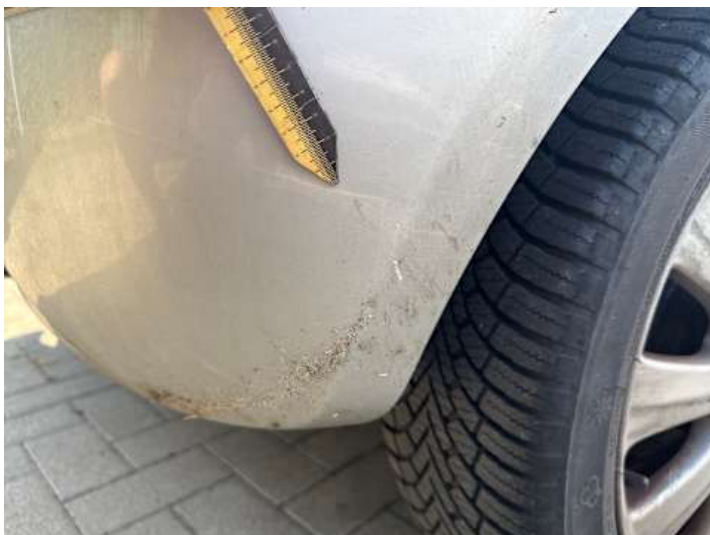
Stoßstange hinten (Lackschaden)
