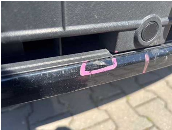
Stoßstange vorne (Delle, Kratzer)
