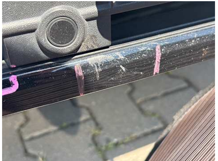
Stoßstange vorne (Delle, Kratzer)
