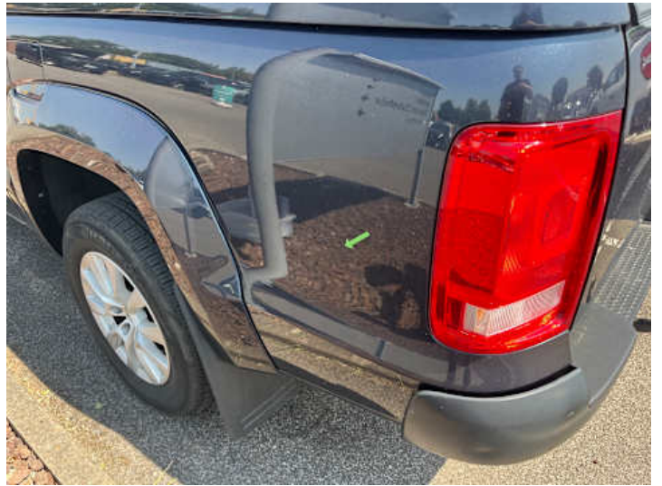
Seitenteil hinten links (Lackschaden, Kratzer)
