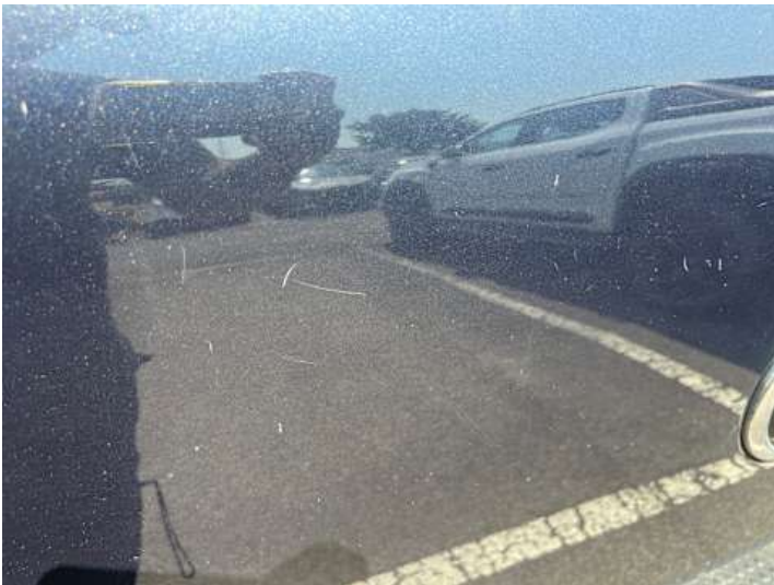
Heckklappe (Lackschaden, Kratzer)
