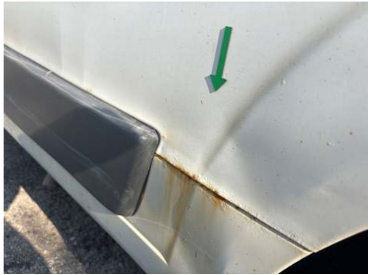
Seitenteil hinten links (Rost)
