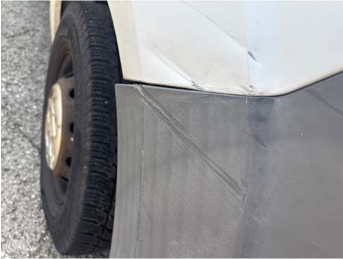
Stoßstange vorne (Kratzer, Spaltmaße ungenau)
