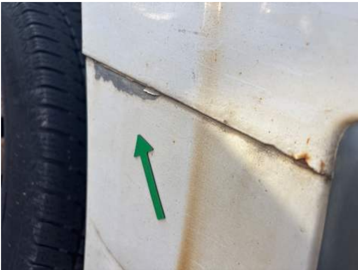
Seitenteil hinten rechts (Lackschaden, Rost)
