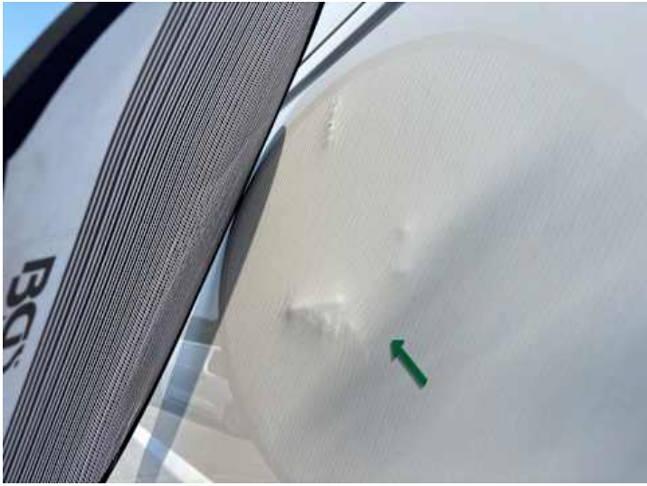
Seitenteil hinten links (Verformung)
