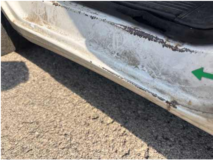
Schweller links (Kratzer)
