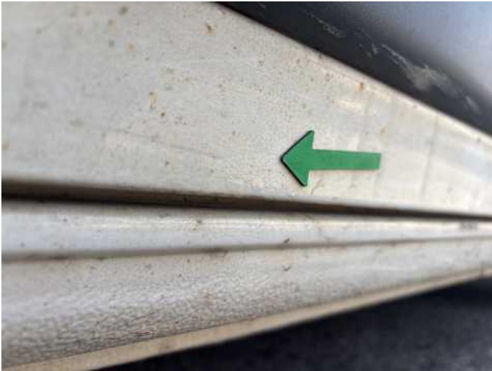
Türe hinten rechts (Rost)
