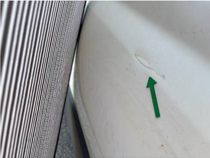
Türe hinten rechts (Kratzer, Verformung)
