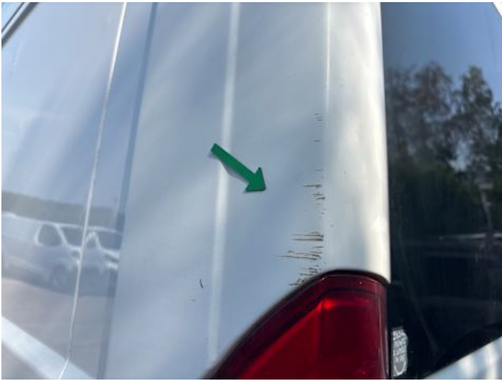
Seitenteil hinten links (Kratzer)
