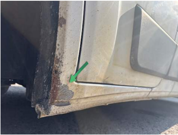
Schweller links (Lackschaden)
