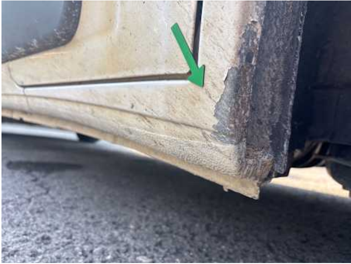
Schweller rechts (Lackschaden)
