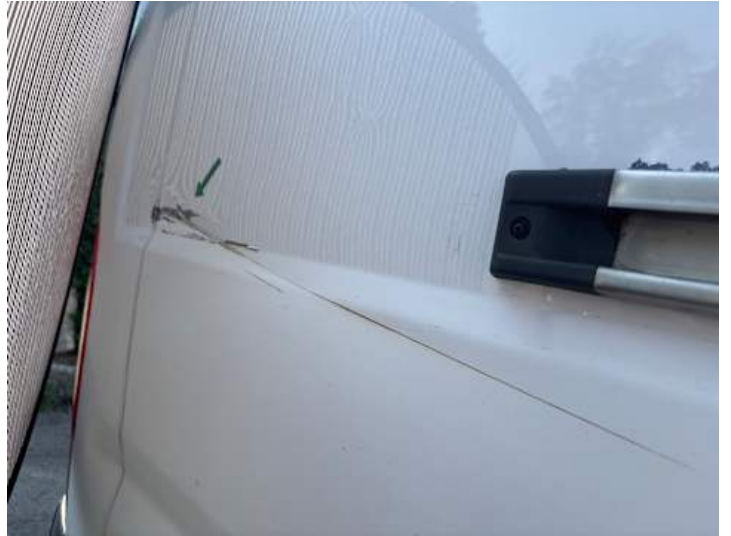
Seitenteil hinten rechts (Kratzer, Verformung, Rost)
