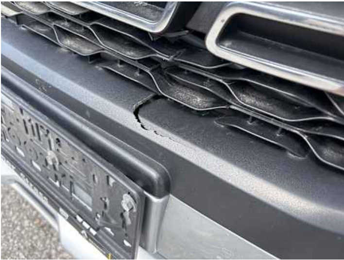
Stoßstange vorne (Verformung, Kratzer, Riss/Bruch)
