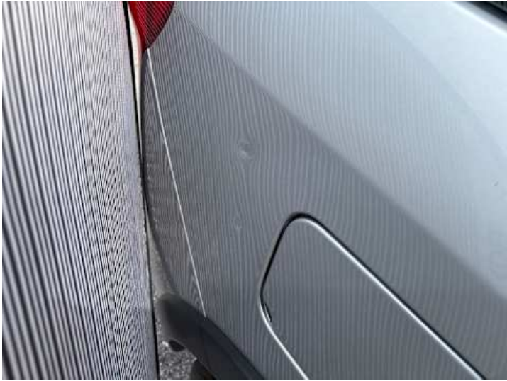
Seitenteil hinten rechts (Delle)
