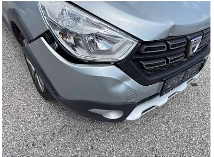
Stoßstange vorne (Verformung, Kratzer, Riss/Bruch)
