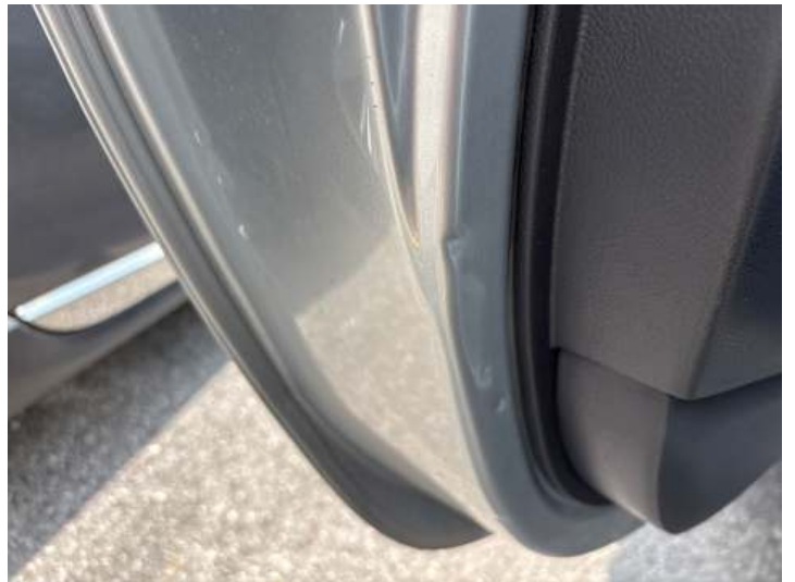
Türe hinten links (Delle)
