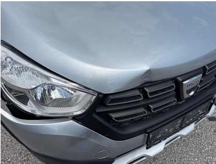
Motorhaube (Verformung, Lackschaden)
