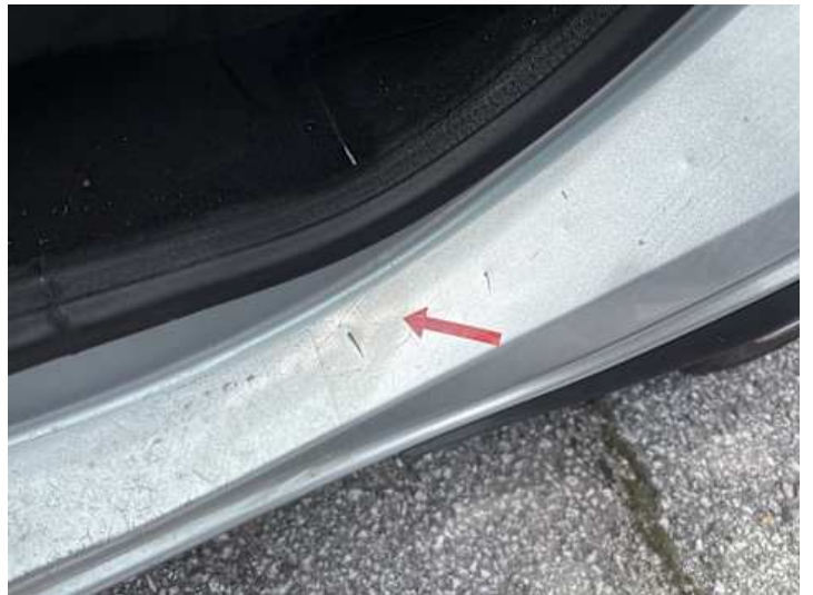
Schweller links (Delle, Lackschaden)
