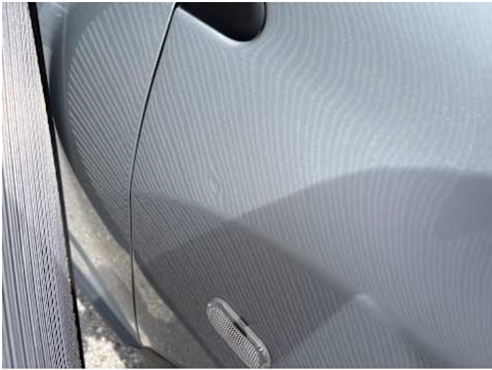
Kotflügel vorne rechts (Delle)
