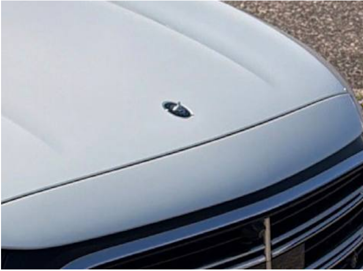
Motorhaube (Anderer Schaden): Mercedes Elblem abgebrochen
